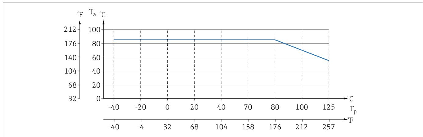
図 8 断熱材を使用しない垂直取付時の値
