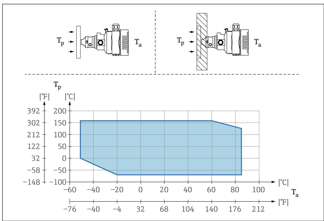
T<sub>a</sub> 変換器の周囲温度
