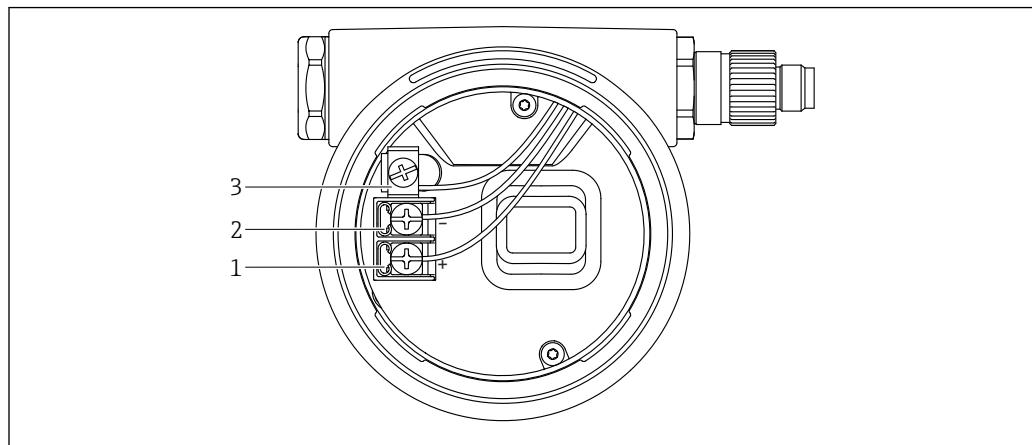
図 3 端子部の接続端子と接地端子
