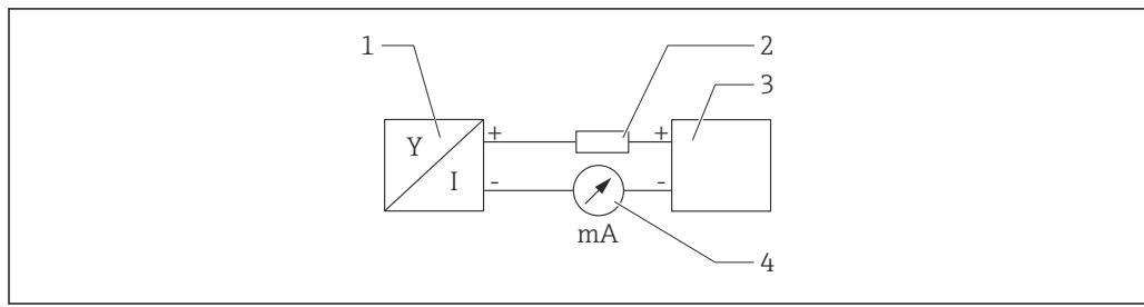
図 2 HART 接続のブロック図
