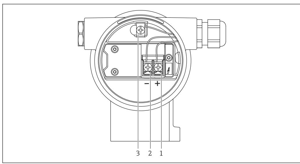
図 4 端子部の接続端子と接地端子
