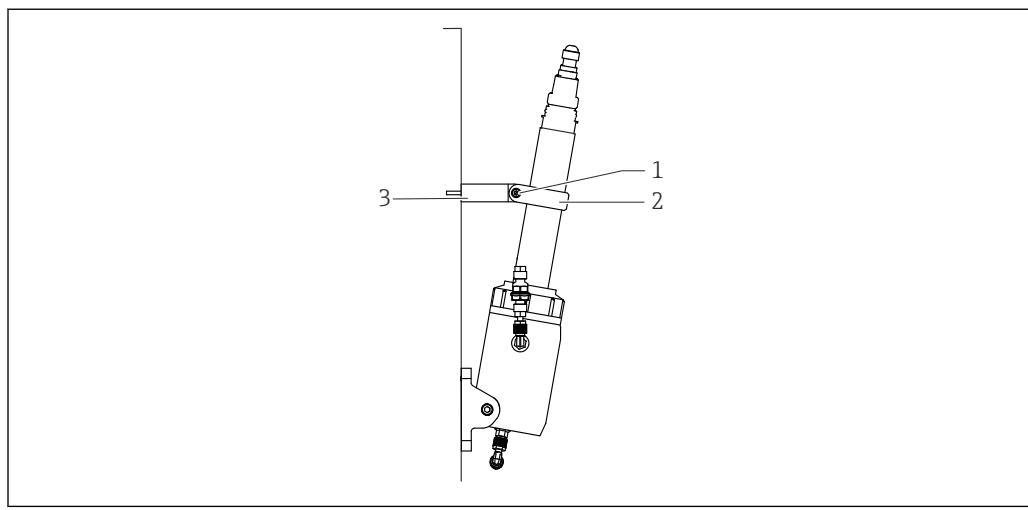
图 29 传感器, 安装有安装支架
