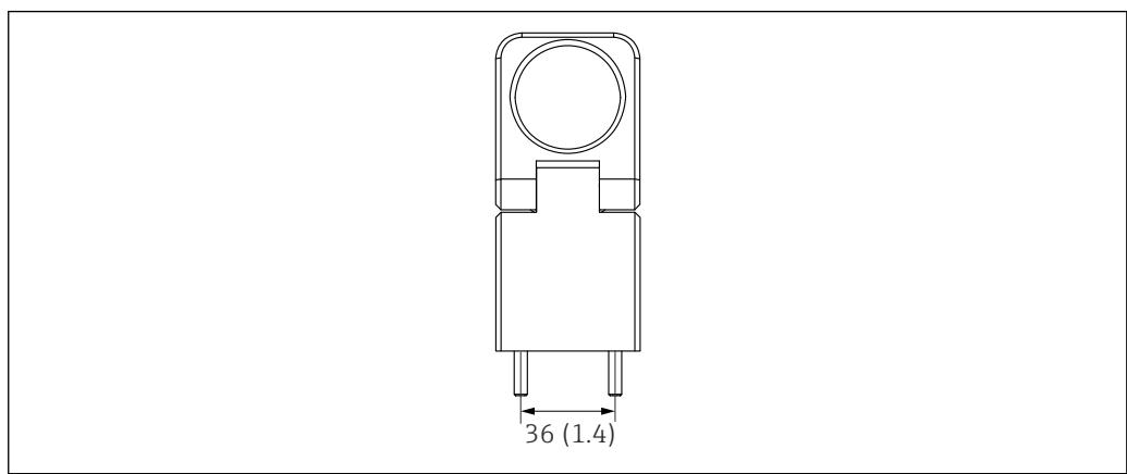
图 6 卡环带定位盘的外形尺寸, 单位: mm (in)
