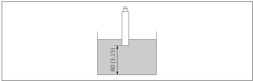
图 9 安装传感器。外形尺寸: mm (in)
