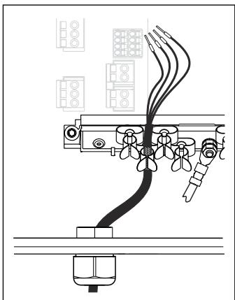
图 21 接地夹夹紧电缆
