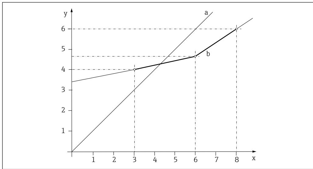
图 26 多点标定原理（三点）
