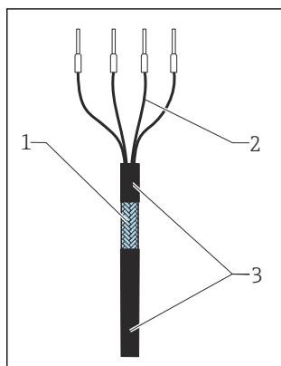
图 19 端接电缆
