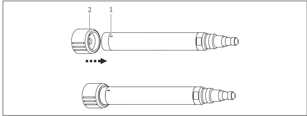
图 17 将固态标定模块安装在传感器上
