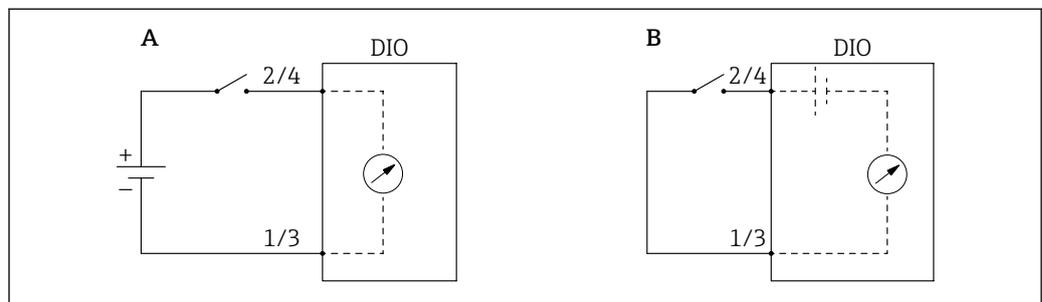
A "Mode de fonctionnement" = "Input passive"
