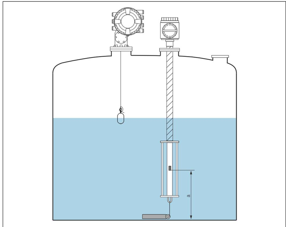
59 Prothermo NMT53x : position de l'élément de température du fond
