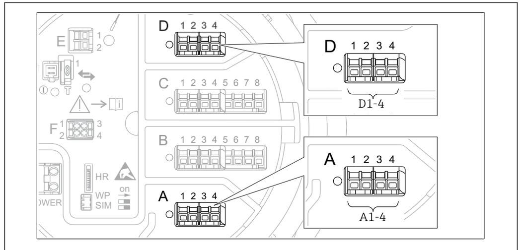
**71** Emplacements possibles des modules Modbus (exemples) ; selon la version d'appareil, ces modules peuvent également se trouver dans les slots B ou C → 49.
