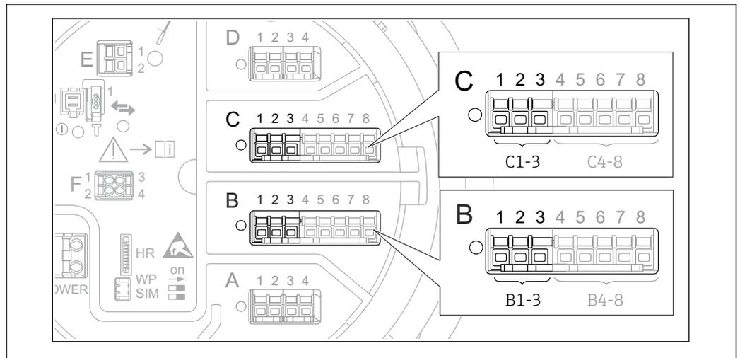
68 Emplacements possibles des modules Analog I/O, pouvant être utilisés comme sortie 4-20 mA. La référence de commande de l'appareil détermine le module réellement présent → 49.
