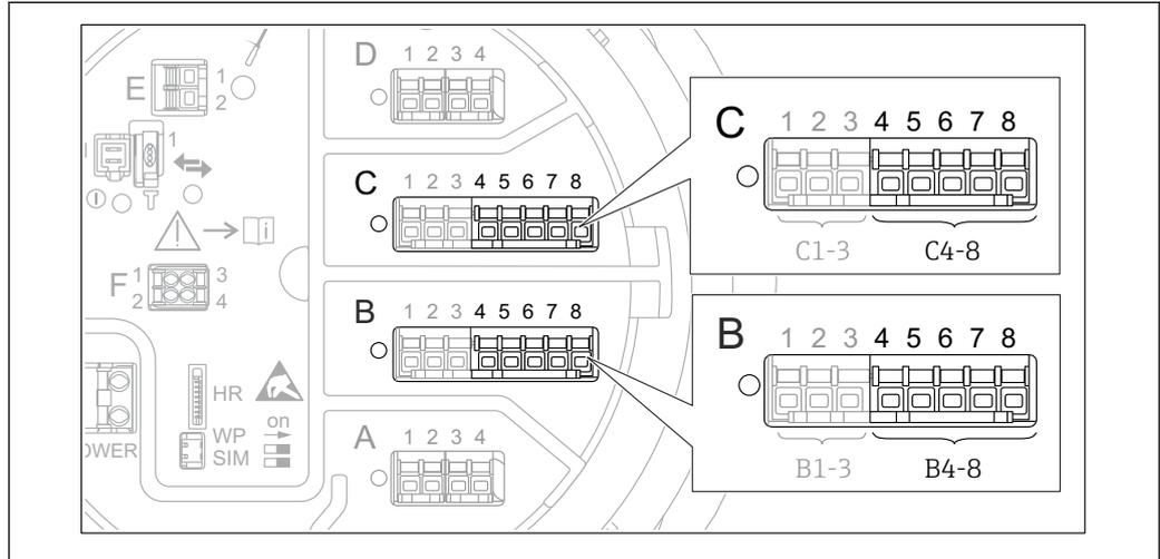
87 Bornes pour le sous-menu "Analog IP" ("B4-8" ou "C4-8", respectivement)
