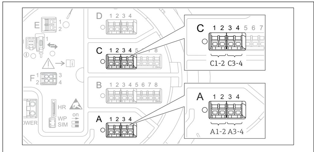
65 Emplacements possibles des modules Digital I/O (exemples) ; la référence de commande détermine le nombre et l'emplacement des modules d'entrée numériques → 49.
