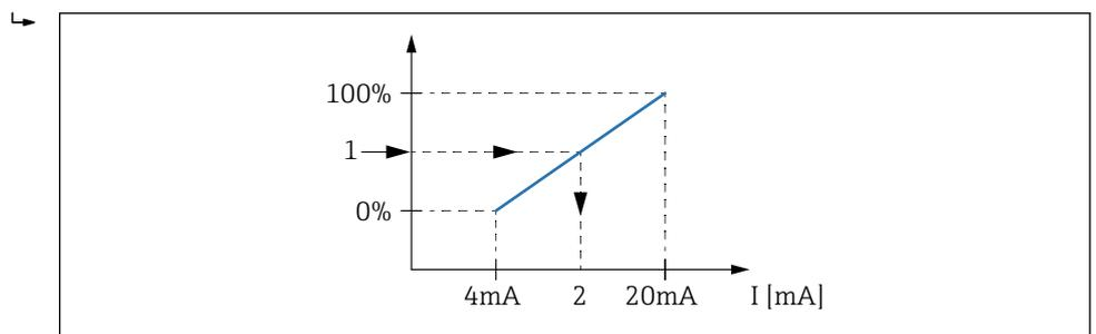
69 Mise à l'échelle de la variable de cuve en fonction du courant de sortie
