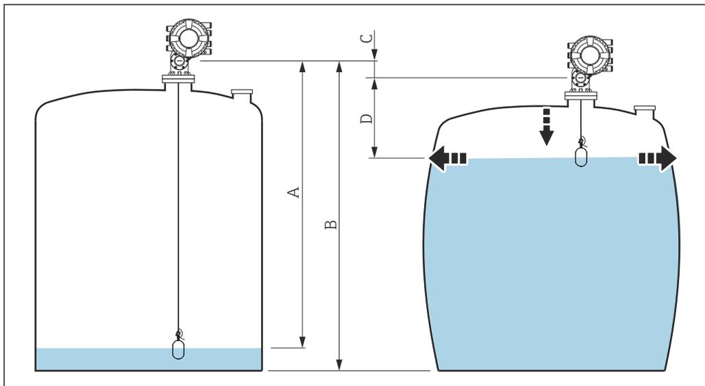
66 Correction de la déformation hydrostatique du réservoir (HyTD)
