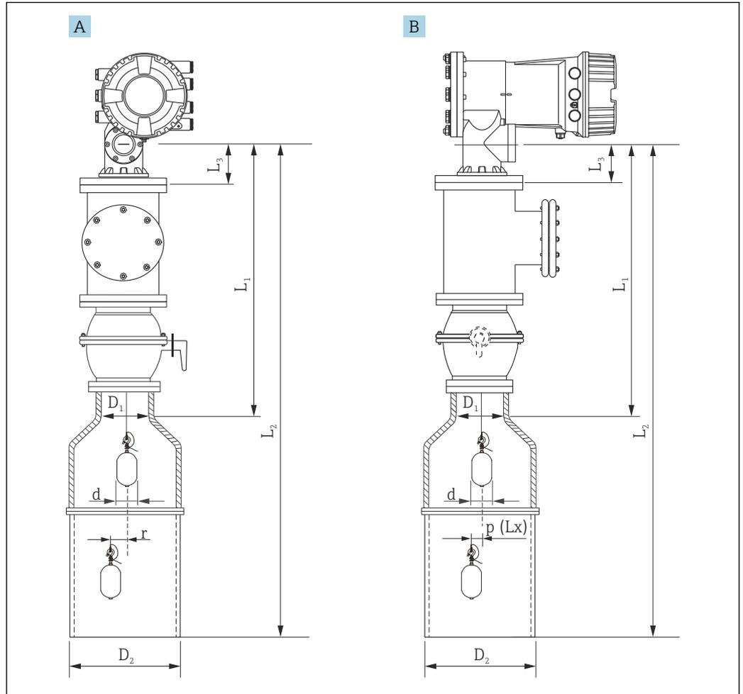
7 Montage avec un tube de mesure concentrique
