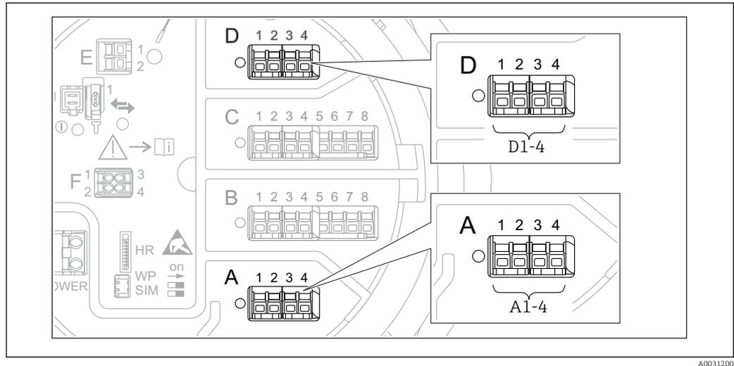
92 Désignation des modules "Modbus", "V1" ou "WM550" (exemples) ; selon la version d'appareil, ces modules peuvent également se trouver dans les slots B ou C.
