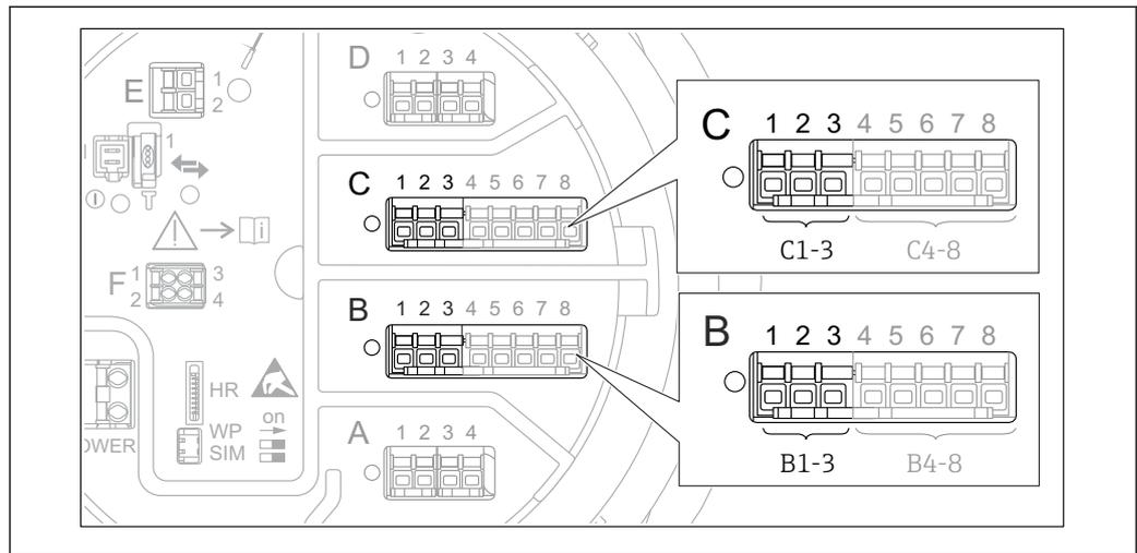
88 Bornes pour le sous-menu "Analog I/O" ("B1-3" ou "C1-3", respectivement)
