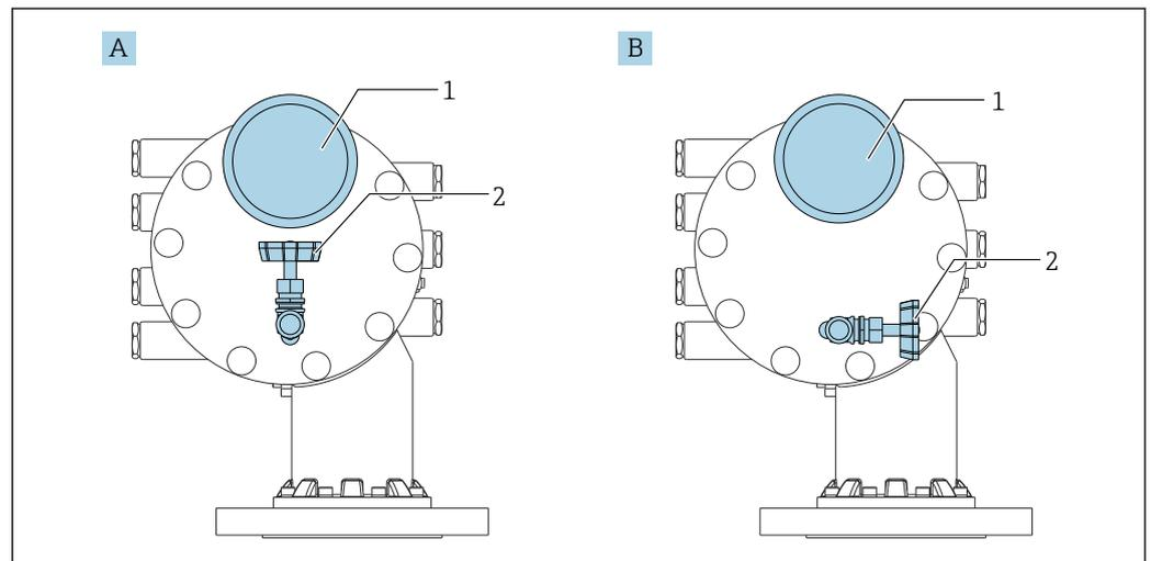
79 Position de montage de la soupape de décharge et du manomètre
