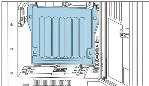
Снимите крышку, закрепленную крючками.
