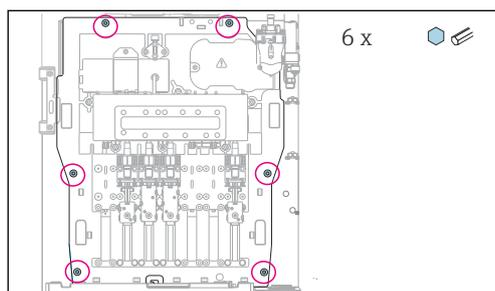
Выверните 6 винтов крепежной панели шестигранным ключом.
