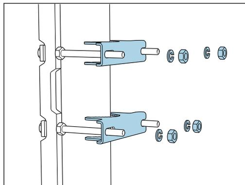
С другой стороны наденьте на стяжные болты вторую часть фиксатора, закрепите пружинными шайбами и гайками.
