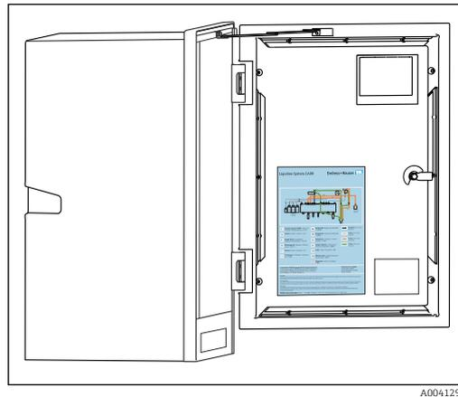
На следующих схемах отражено состояние на момент выпуска этой документации. Схема подсоединения шлангов, действительная для конкретного исполнения прибора, представлена на внутренней стороне дверцы анализатора.
