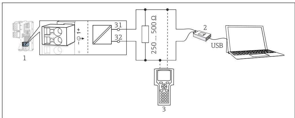
Фото 25 Передача данных по протоколу HART посредством модема
