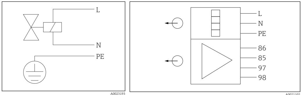
10 Блок-схема подготовки пробы, Liquiline System CAT810 с очистным клапаном
