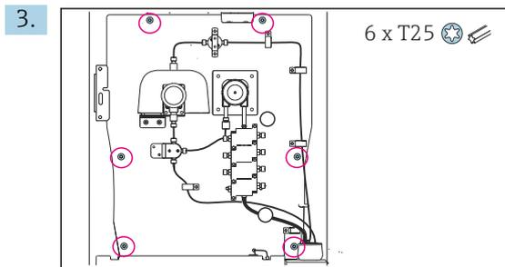
Dévisser les 6 vis sur la plaque porteuse à l'aide d'un tournevis Torx (T25).
