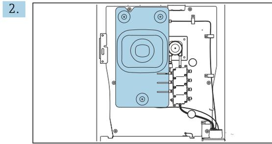
Desserrer les vis du couvercle et retirer le couvercle.
