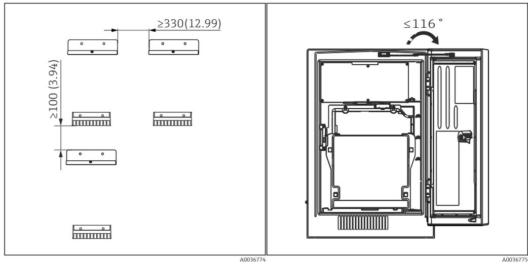
12 Distance de montage requise. Unité de mesure mm (in). 13 Angle d'ouverture maximale
