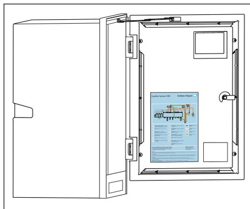
Les diagrammes ci-dessous reflètent l'état au moment de la publication de cette documentation. Le schéma de raccordement des tuyaux qui s'applique à la version d'appareil est présent à l'intérieur de la porte de l'analyseur.
