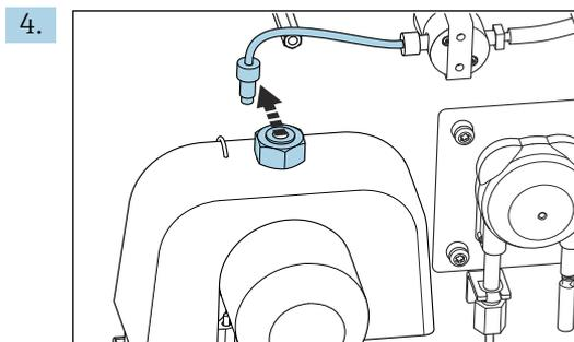
Desserrer le raccord de tuyau sur l'ouverture du réacteur et retirer le tuyau.
