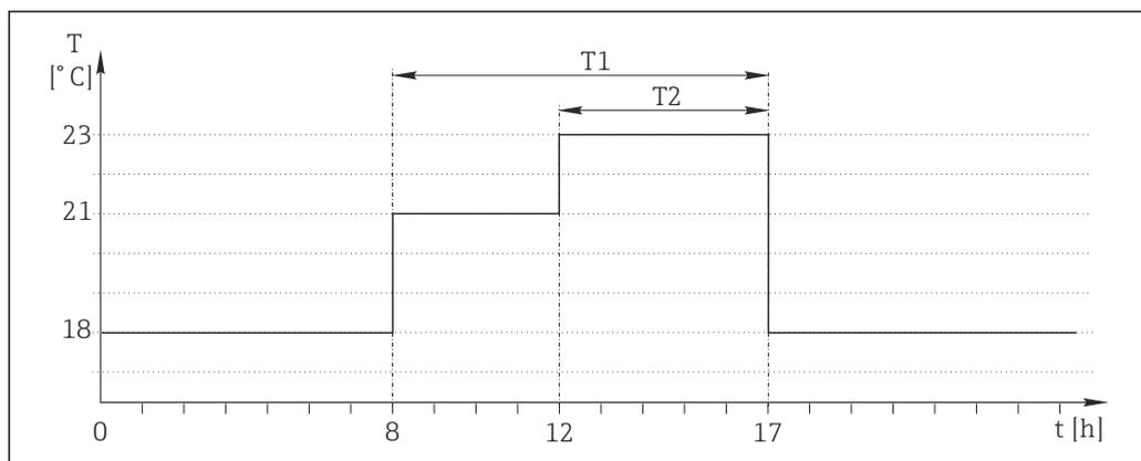
61 Régulation de température basée sur le temps
