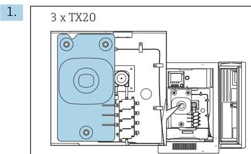
Desserrer les 3 vis Torx sur le couvercle transparent du réacteur.
