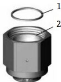
Fig 71. Centrado de la junta sobre la superficie de sellado del sombrero
