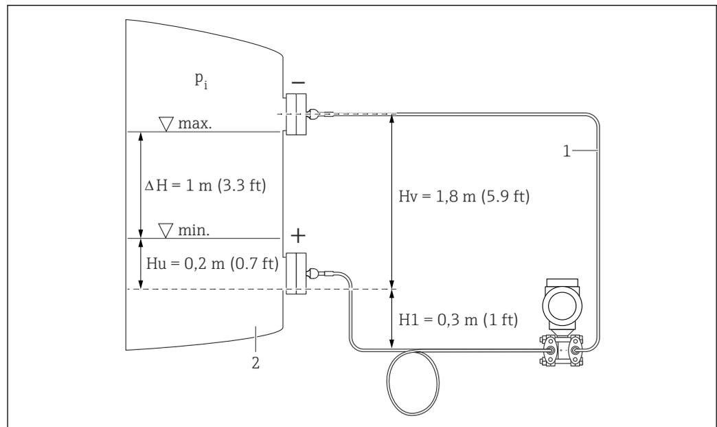
1 采用硅油填充液的毛细管： $\rho_{FI} = 0.96 \text{ kg (2.12 lb) dm}^3$
