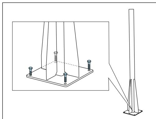
支柱を直立させて、4本の固定ネジ（ユーザー側で用意してください<sup>1)</sup>）を使用して基礎にしっかりと固定します。
