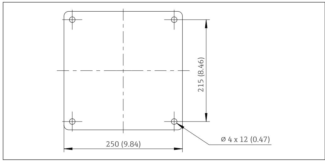
図 22 基礎図 (寸法単位 : mm (in))
