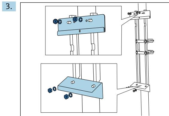
壁取付ユニット（アナライザの納入範囲に含まれます）を支柱固定器具に取り付けます。
