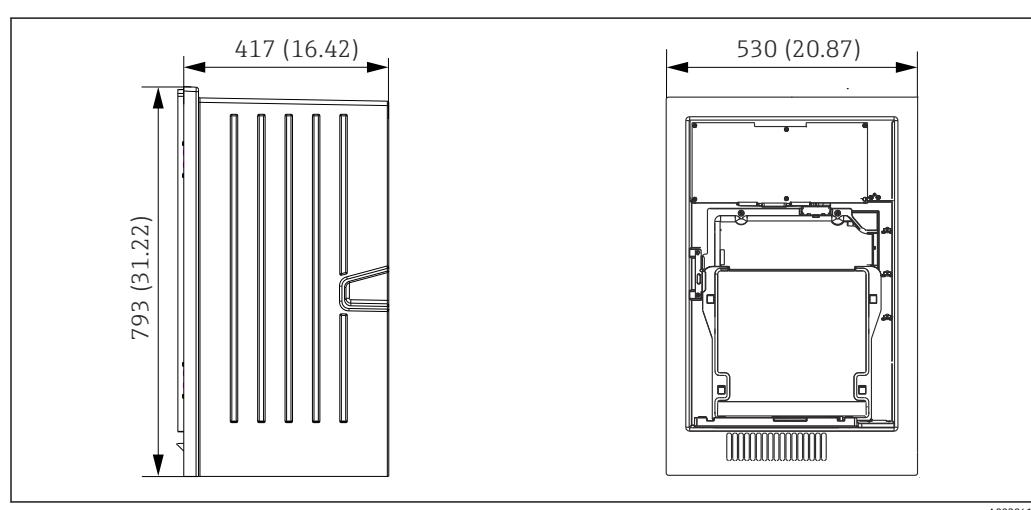
図 14 Liquiline System CA80 開放型、寸法単位 mm (in)
