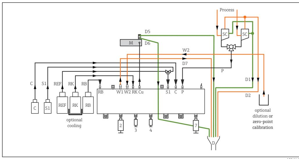
図 65 Liquiline System CA80AM、2 チャンネル機器
