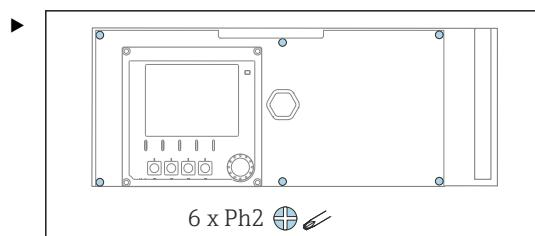
プラスドライバーを使用して、電子部カバーの 6 本のネジを緩め、カバーを正面方向に傾けます。
