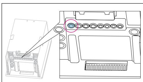
電源ケーブル（ユーザー側が設置場所で用意してください）を図に示されたケーブルグランドに通します。
