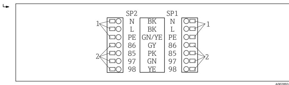
図 31 Liquiline System CAT820/860 の接続
