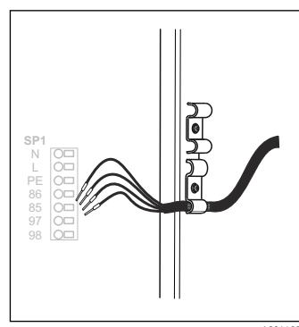
図 30 ネジを締め付ける（2 Nm）
