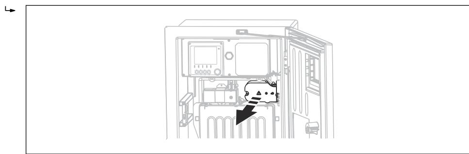
8. 露出しているケーブルシールドをケーブルクランプの 1 つにはめ込み、プラグイン端子までケーブルコアを簡単に配線できるように、ハウジング内でケーブルを配線します。
