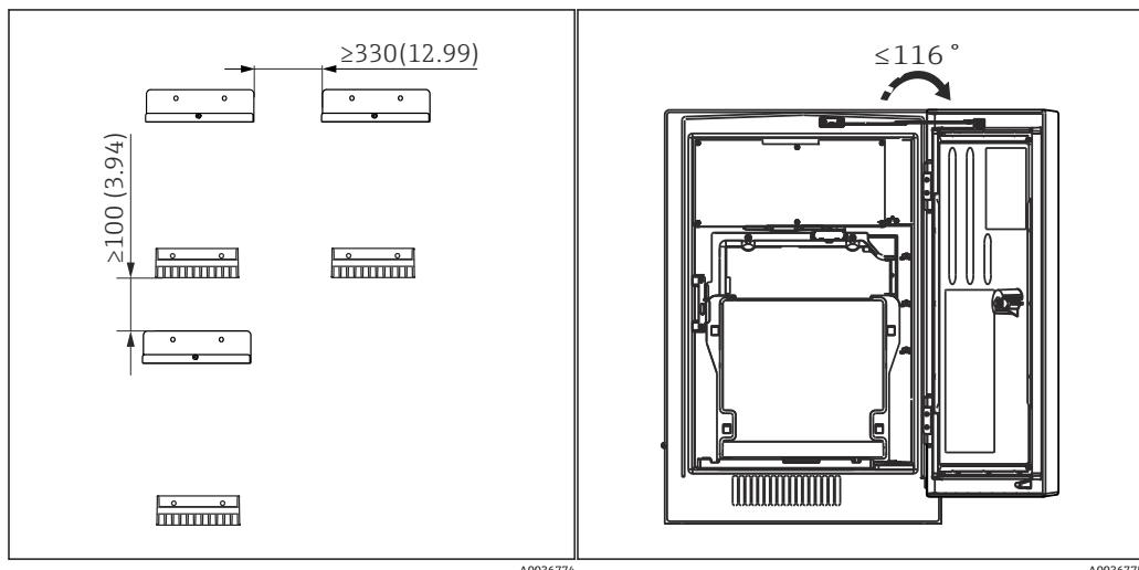
図 17 取付けに必要な最小設置スペース。単位 mm (in)
