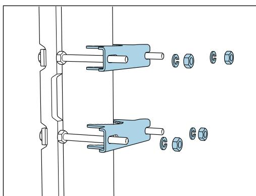
スプリングワッシャとナットを使用して、もう一方のクランプも取り付けて支柱固定器具を締め付けます。
