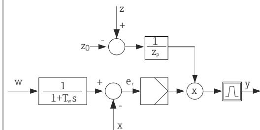
厳密に言えば、フィードフォワード制御はその影響が直接測定できないため、オープンループ制御システムに含まれます。これはつまり、フィードフローが前方にのみ向いていることを意味します。そのため、「フィードフォワード制御」という名称が付けられています。
