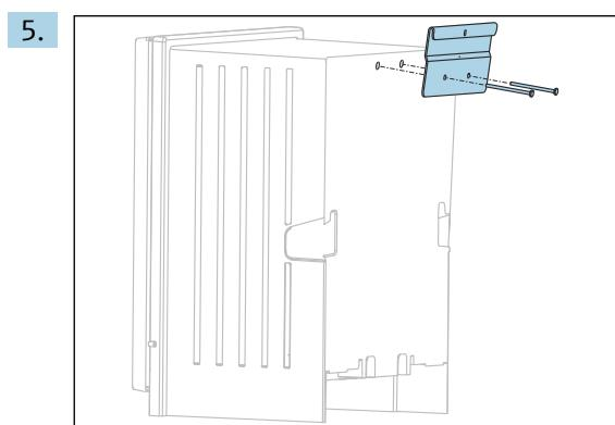
壁取付ユニットのサスペンションブラケット（アナライザの納入範囲に含まれます）をアナライザにネジ込みます。
