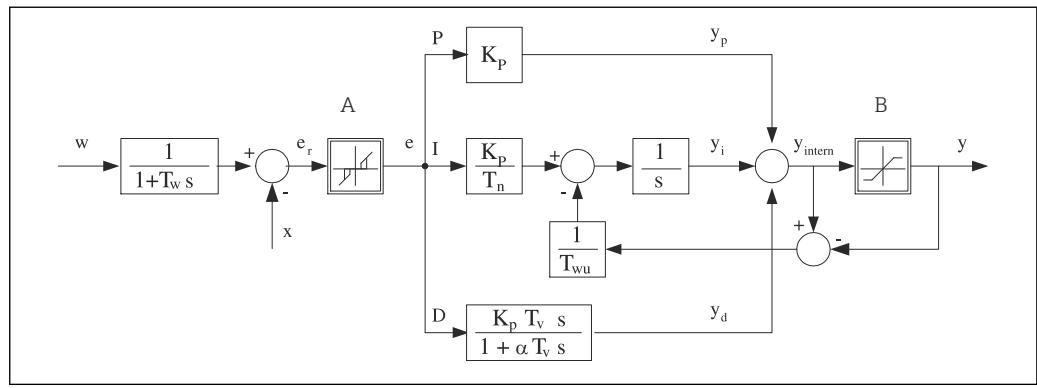
図 77 コントローラ構造のブロック図
