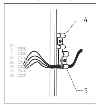
図 29 ケーブルの挿入
