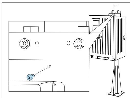
付属のネジを使用して、壁取付ユニットの上部を固定します。
