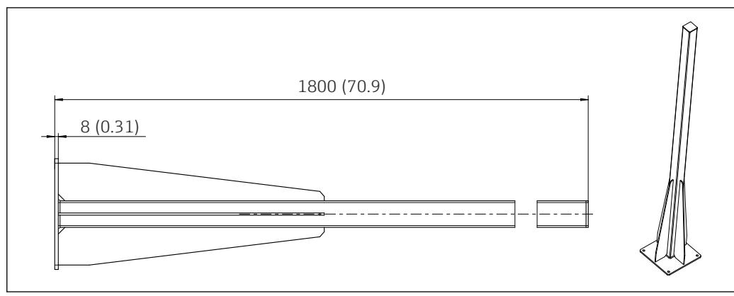
図 16 「屋外」バージョン用支柱（アクセサリ）(寸法単位 : mm (inch))
