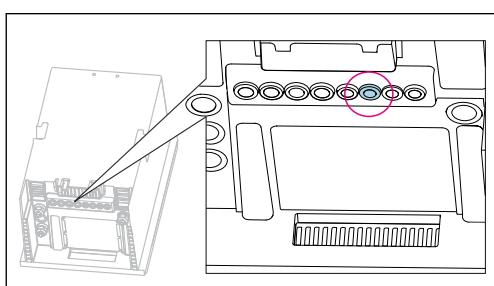
ヒーター付き排水ホースのケーブルを図に示されたケーブルグランドに通します。
