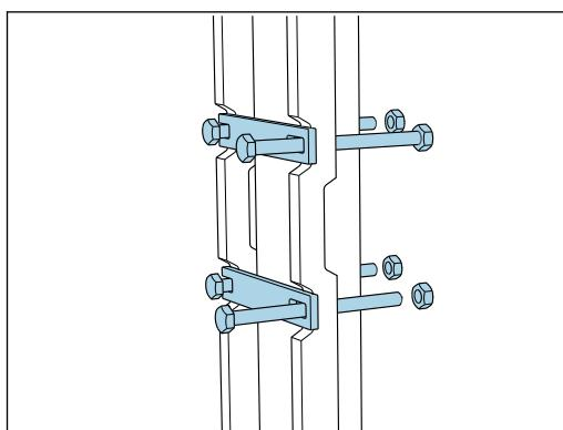
ナットを使用して、支柱固定器具のクランプを支持ロッドと支柱に取り付けます。
