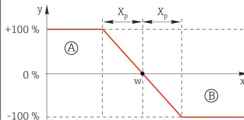
図 79 赤色: 2 つの 1 サイドコントローラの曲線間の重複を示しています。
