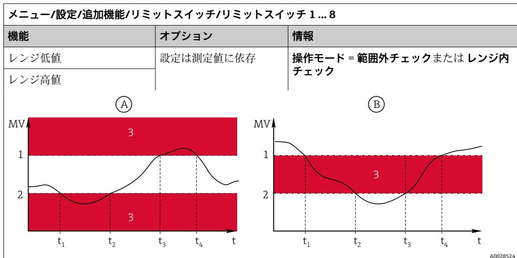
図 72 監視レンジの範囲外 (A) と範囲内 (B) (ヒステリシスとスイッチオン遅延なし)
