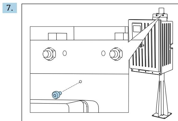
付属のネジを使用して、壁取付ユニットの上部を固定します。
