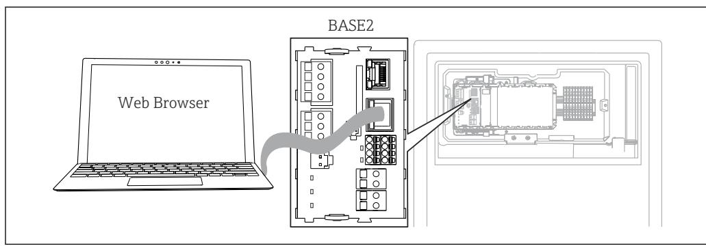
図 58 Web サーバー/Ethernet 接続
