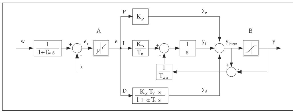
図 77 コントローラ構造のブロック図
