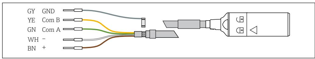
図 34 Memosens データケーブル CYK10 の例
