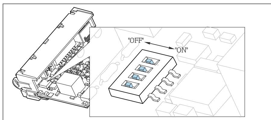
図 53 内部終端処理用の DIP スイッチ
