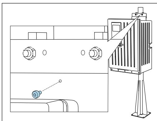
付属のネジを使用して、壁取付ユニットの上部を固定します。
