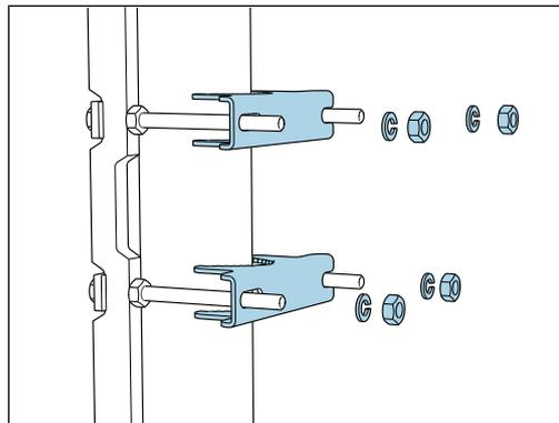
スプリングワッシャとナットを使用して、もう一方のクランプも取り付け支柱固定器具を締め付けます。
