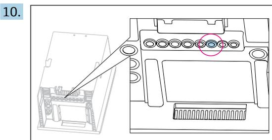
ヒーター付き排水ホースのケーブルを図に示されたケーブルグランドに通します。
