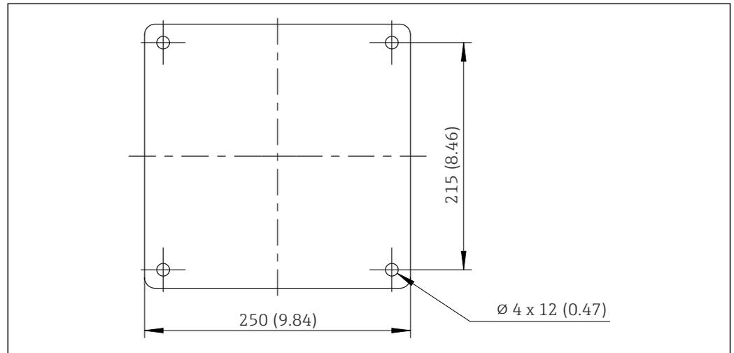
図 22 基礎図 (寸法単位 : mm (in))
