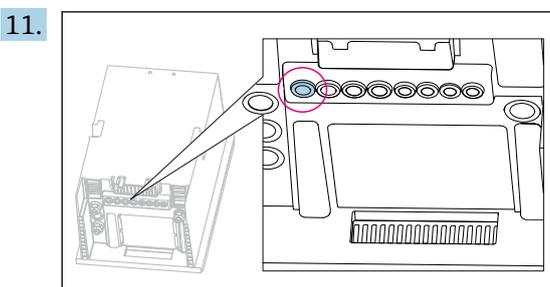
電源ケーブル（ユーザー側が設置場所で用意してください）を図に示されたケーブルグランドに通します。
