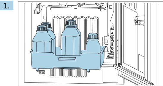
ボトルトレイを取り外します：凹型グリップをわずかに持ち上げ、正面方向に引きます。
