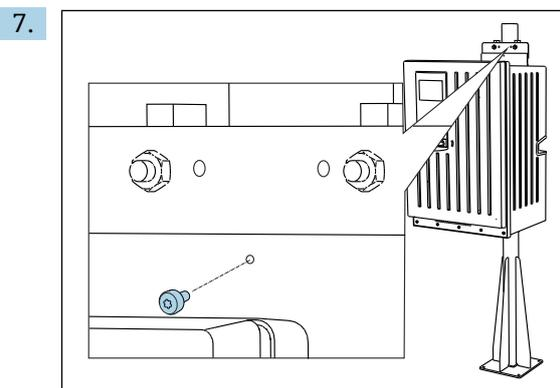
付属のネジを使用して、壁取付ユニットの上部を固定します。
