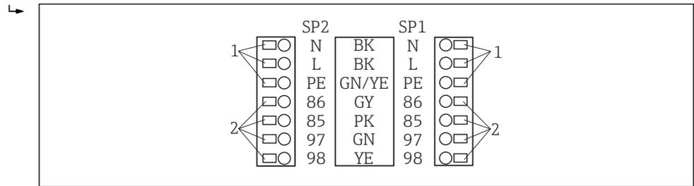
図 31 Liquiline System CAT820/860 の接続
