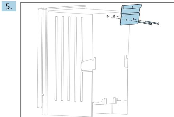
壁取付ユニットのサスペンションブラケット（アナライザの納入範囲に含まれます）をアナライザにネジ込みます。
