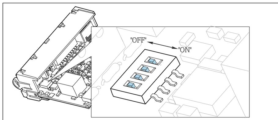
図 53 内部終端処理用の DIP スイッチ
