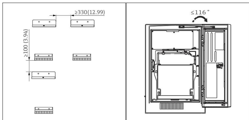
16 Spaziatura minima richiesta per il montaggio. 17 Angolo di apertura massimo
