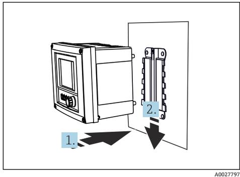
图 12 安装设备，并固定到位
