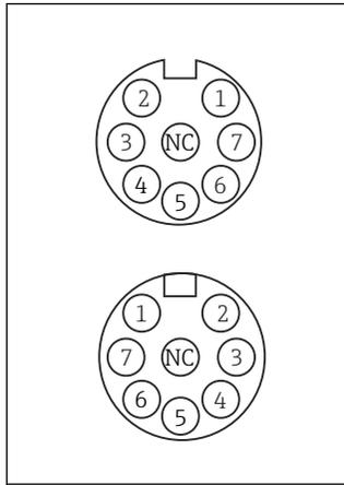
图 29 M12 接头; 上图: 插座; 下图: 插头 (均为俯视图)
