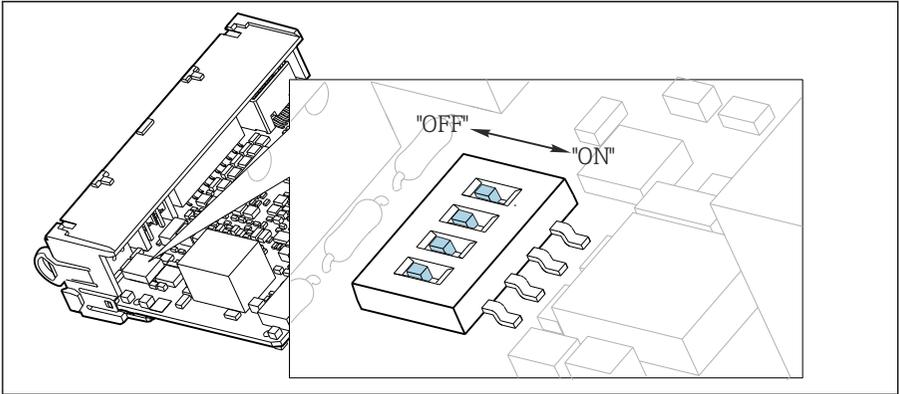
图 55 内部端接的 DIP 开关
