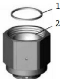
Fig 71. Centralização da junta na superfície de vedação da tampa
