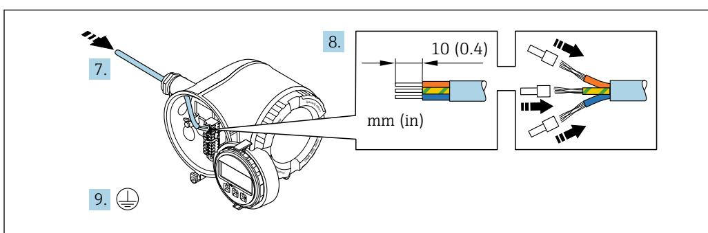
7. Empurre o cabo através da entrada para cabo. Para garantir a vedação estanque, não remova o anel de vedação da entrada para cabos.
