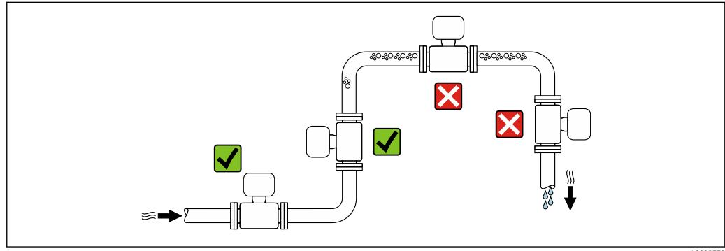
Para evitar erros de medição resultantes do acúmulo de bolhas de gás na tubulação de medição, evite os seguintes locais de instalação na tubulação:
