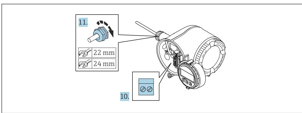
10. Conecte o cabo de acordo com o esquema de ligação elétrica .
