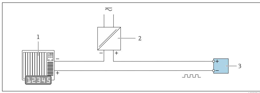
■ 13 Exemplo de conexão para saída por pulso/frequência (passiva)
