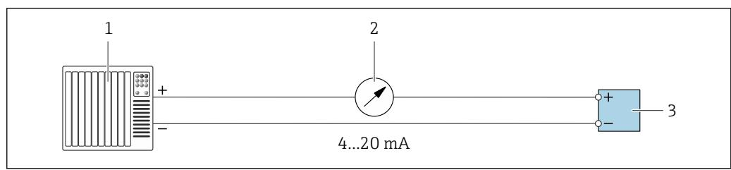
■ 11 Exemplo de conexão para saída de corrente 4-20 mA (ativa)
