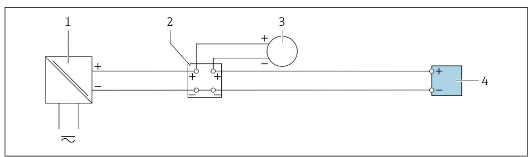
■ 18 Exemplo de conexão para entrada em corrente de 4 a 20 mA
