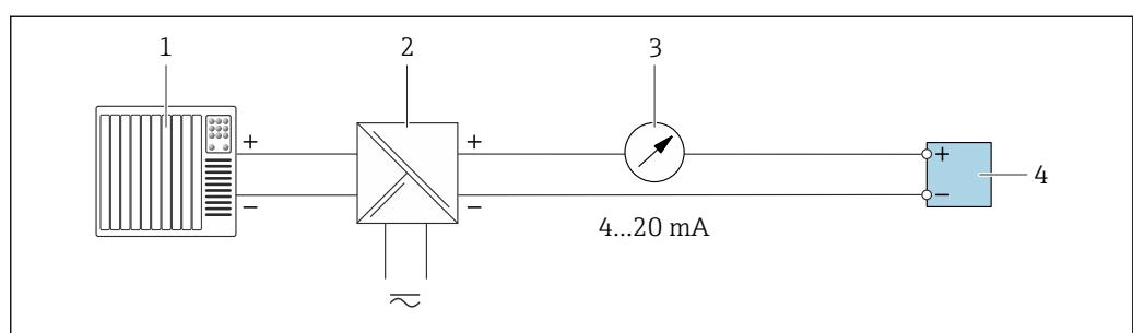
■ 12 Exemplo de conexão para saída de corrente 4-20 mA (passiva)
