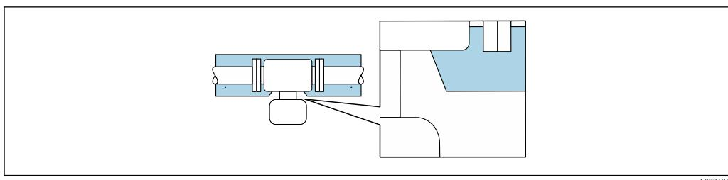
5 Isolamento térmico com pescoço de extensão não isolado
