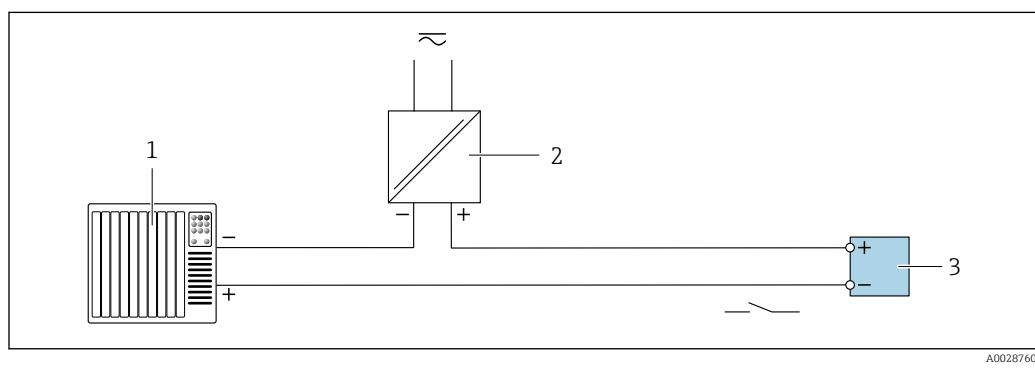
■ 14 Exemplo de conexão para saída comutada (passiva)
