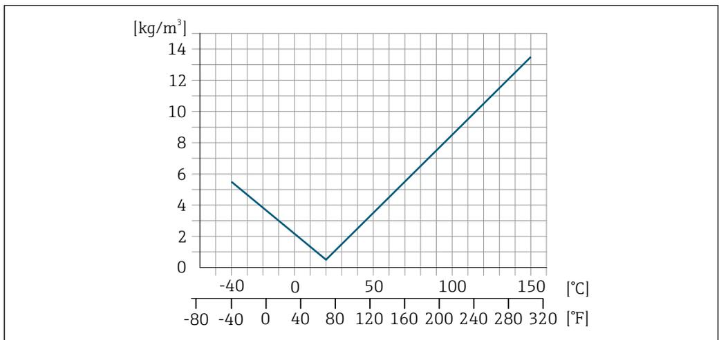
39 Ajuste da densidade de campo, por exemplo, a  $+20 \text{ }^\circ\text{C}$  ( $+68 \text{ }^\circ\text{F}$ )
