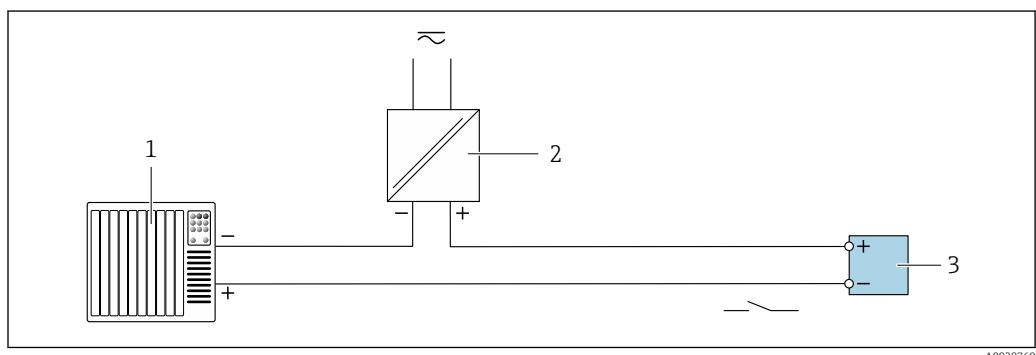
■ 24 Exemplo de conexão para saída a relé (passiva)
