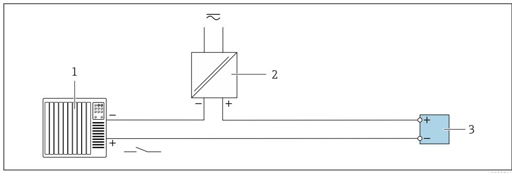
Fig 26 Exemplo de conexão para entrada de status
