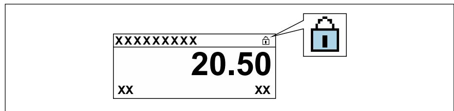
5. O ajuste da chave de Proteção (WP) contra gravação no módulo de eletrônica principal para a posição **OFF** (ajuste de fábrica) desabilita a proteção contra gravação de hardware.
