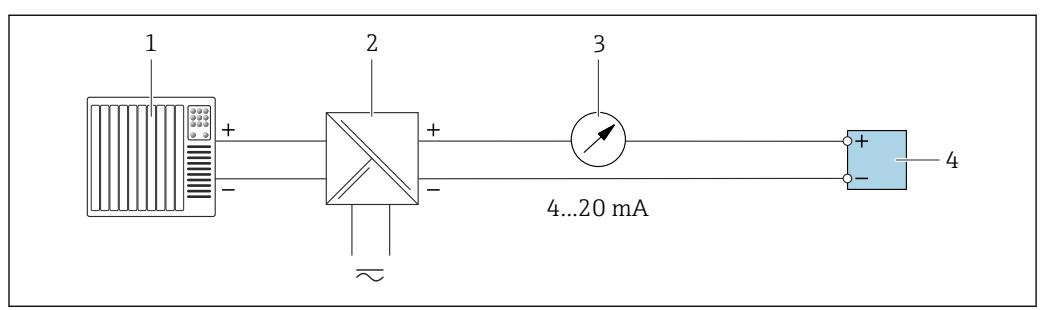
■ 19 Exemplo de conexão para saída de corrente 4-20 mA (passiva)
