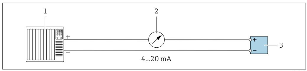
■ 18 Exemplo de conexão para saída de corrente 4-20 mA (ativa)
