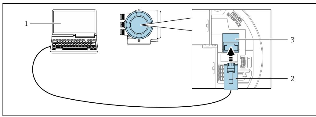
**■ 33 Conexão através de Interface de operação (CDI-RJ45)**
