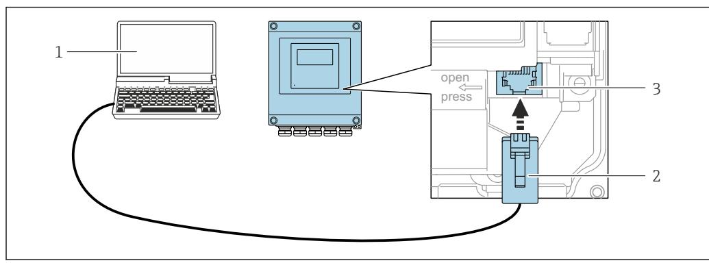
**■ 32 Conexão através de Interface de operação (CDI-RJ45)**
