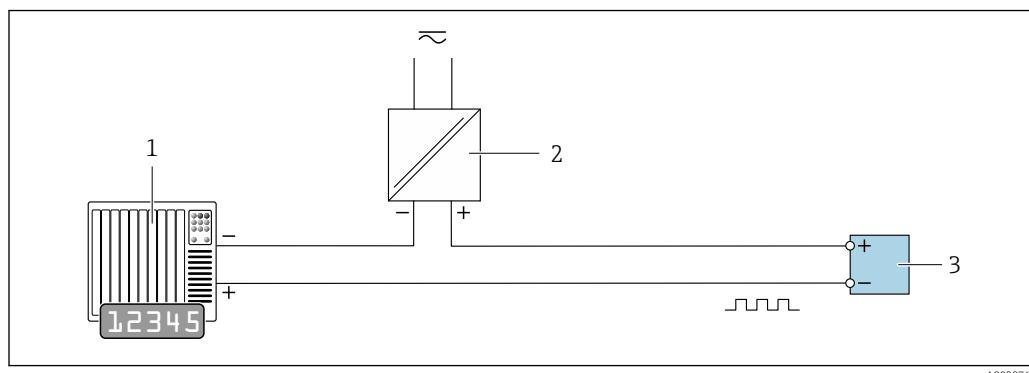
■ 15 Пример подключения для импульсного/частотного выхода (пассивного)
