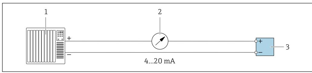
**■ 13 Пример подключения для токового выхода 4–20 мА (активного)**
