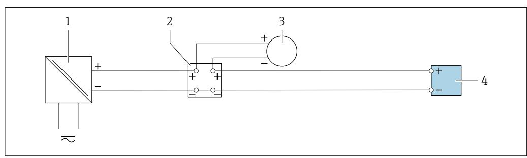
■ 20 Пример подключения для токового входа 4–20 мА
