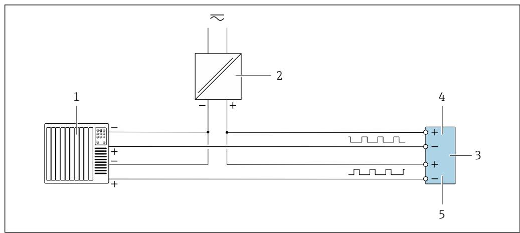
■ 18 Пример подключения двойного импульсного выхода (пассивного)
