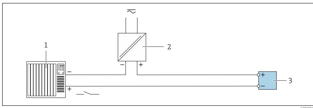
**■ 21 Пример подключения для входного сигнала состояния**
