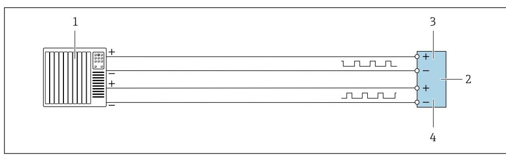
■ 17 Пример подключения двойного импульсного выхода (активного)
