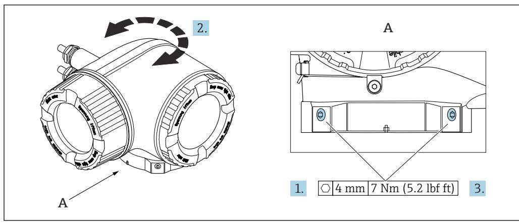
8 Корпус для взрывоопасных зон
