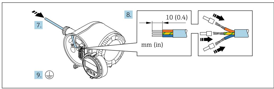
7. Пропустите кабель через кабельный ввод. Чтобы обеспечить непроницаемое уплотнение, не удаляйте уплотнительное кольцо из кабельного ввода.
