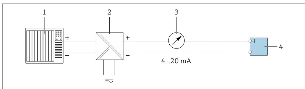
**■ 14 Пример подключения для токового выхода 4–20 мА (пассивного)**
