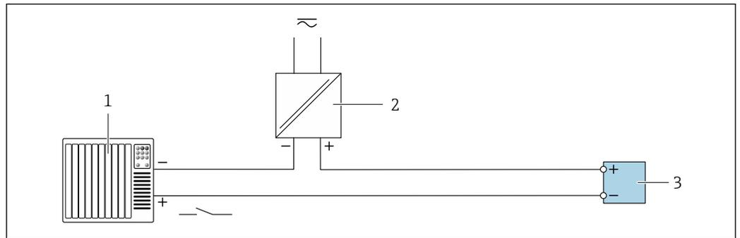
図 28 ステータス入力の接続例
