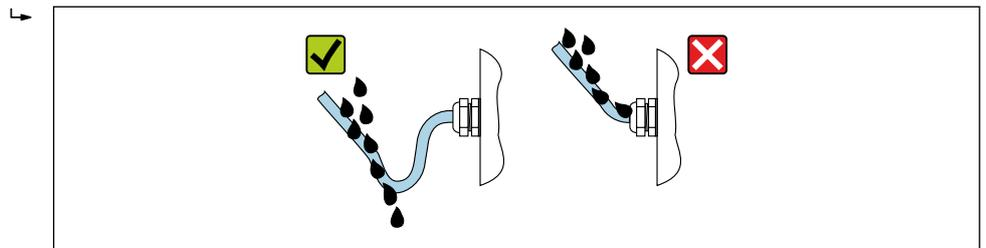
6. ダミープラグ（ハウジングの保護等級に対応）を未使用の電線管接続口に挿入します。
