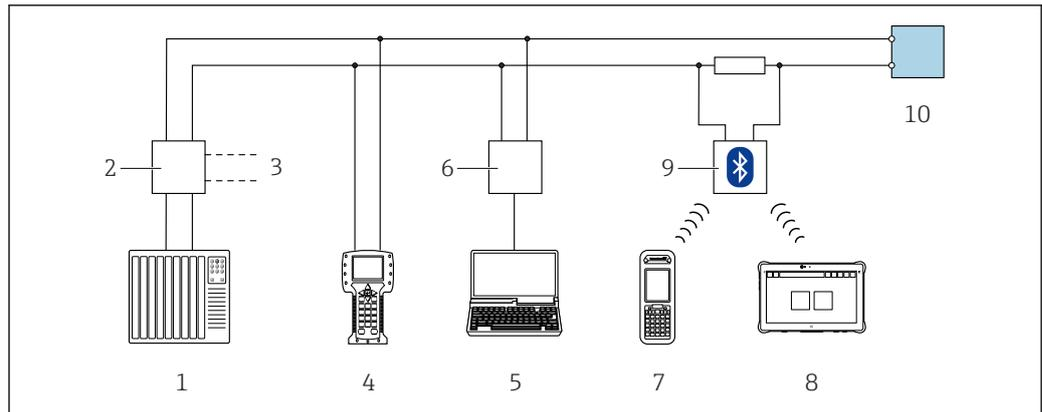
図 34 HART プロトコル経由のリモート操作用オプション (パッシブ)
