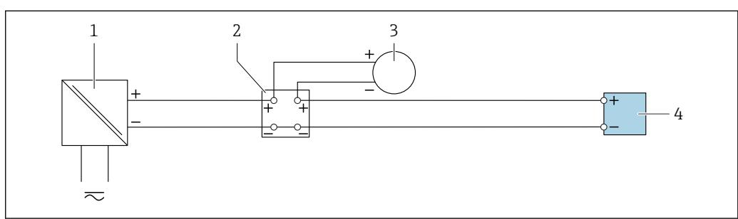
図 28 4~20 mA 電流入力の接続例
