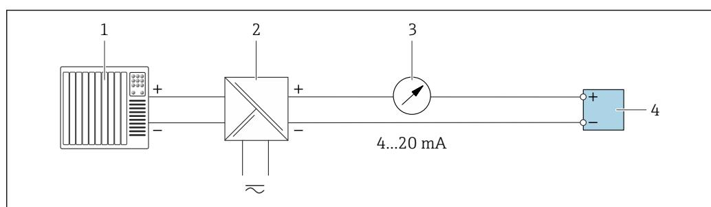
図 22 4~20 mA 電流出力（パッシブ）の接続例
