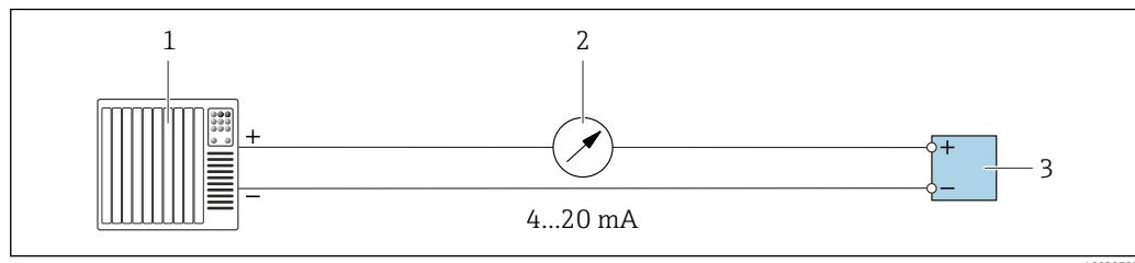
図 21 4~20 mA 電流出力（アクティブ）の接続例
