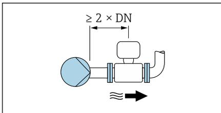
Instalación aguas abajo de las bombas
