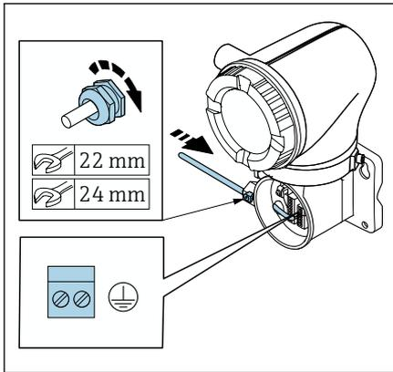
3. Pase el cable de corriente de la bobina y el cable del electrodo a través de la entrada de cable correspondiente.
