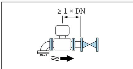
Instalación aguas arriba de válvulas
