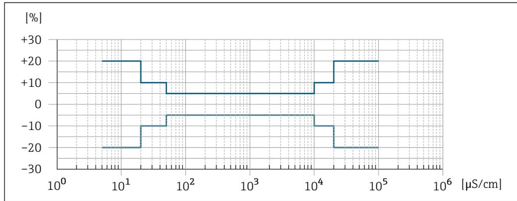
图 24 测量误差 (可选: 订购选项“电导率测量标定”, 选型代号 CW)
