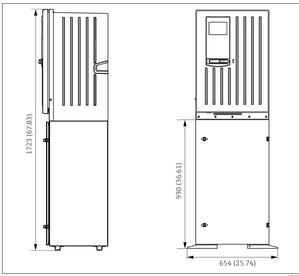
Fig. 22 Liquiline System CA80 com base, dimensões em mm (pol.)
