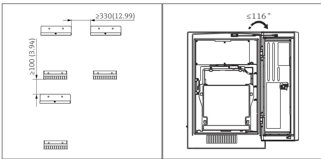
Fig. 17 Espaçamento mínimo necessário para montagem. Unidade de engenharia mm (pol.).
