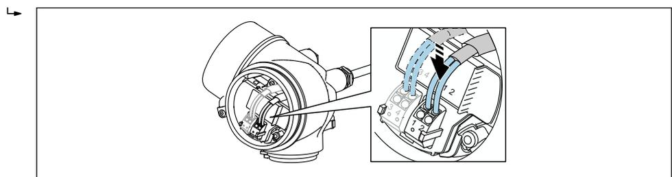
6. Bei Verwendung von abgeschirmtem Kabel: Kabelschirm mit der Erdungsklemme verbinden.
