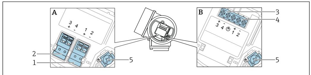
10 Klemmenbelegung 2-Draht: 4 ... 20 mA HART, Schaltausgang
