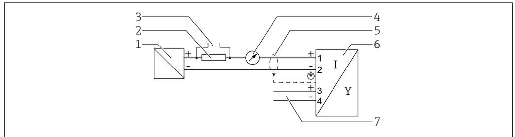
11 Blockdiagramm 2-Draht: 4 ... 20 mA HART, Schaltausgang
