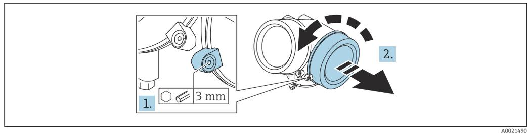
1. Schraube der Sicherungskralle des Anschlussraumdeckels mit Innensechskantschlüssel (3 mm) lösen und Sicherungskralle um 90° gegen den Uhrzeigersinn schwenken.
