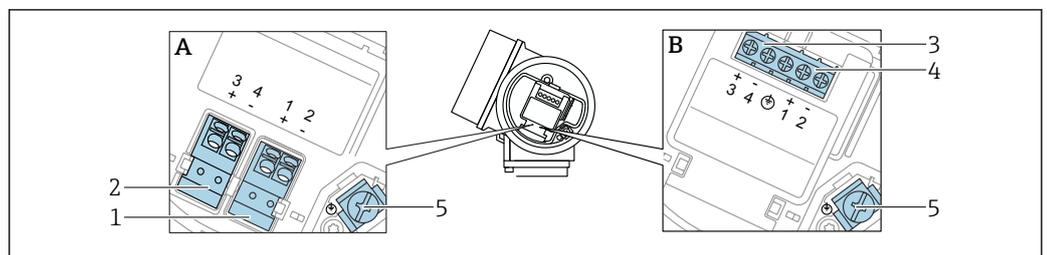
12 Klemmenbelegung 2-Draht: 4 ... 20 mA HART, 4 ... 20 mA
