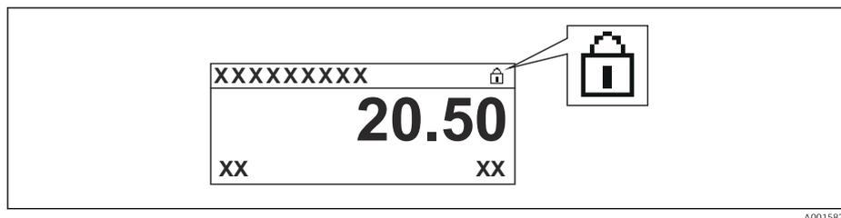
Wenn Hardware-Schreibschutz deaktiviert: In Parameter **Status Verriegelung** wird keine Option angezeigt. Auf der Vor-Ort-Anzeige verschwindet in der Kopfzeile der Betriebsanzeige und in der Navigieransicht vor den Parametern das
