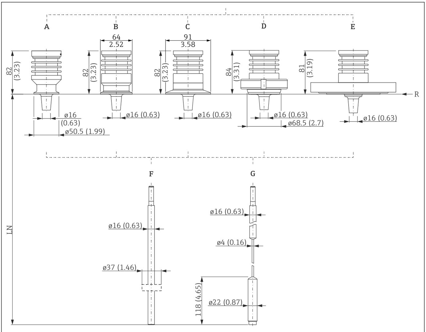
49 FMP52: Prozessanschluss / Sonde. Maßeinheit mm (in)
