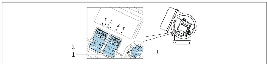
18 Klemmenbelegung 4-Draht: 4 ... 20 mA HART (10,4 ... 48 V<sub>DC</sub>)
