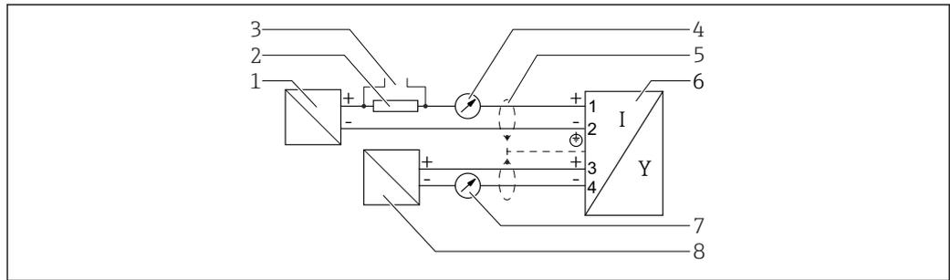
17 Blockdiagramm 2-Draht: 4 ... 20 mA HART, 4 ... 20 mA
