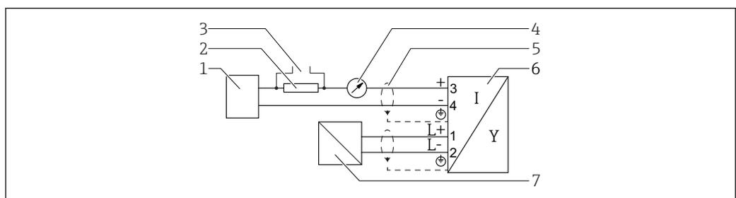
19 Blockdiagramm 4-Draht: 4 ... 20 mA HART (10,4 ... 48 V<sub>DC</sub>)
