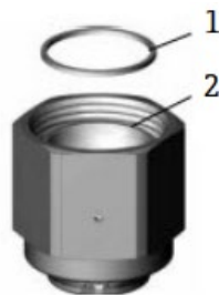
図 71. ガasketをボンネットシール面の中央に配置
