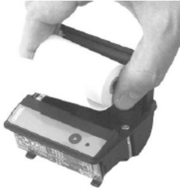
Die neue Papierrolle in das Papierfach einsetzen. Darauf achten, dass die Außenseite zum Druckermechanismus zeigt. Nur die Außenseite des Papiers ist bedruckbar.
