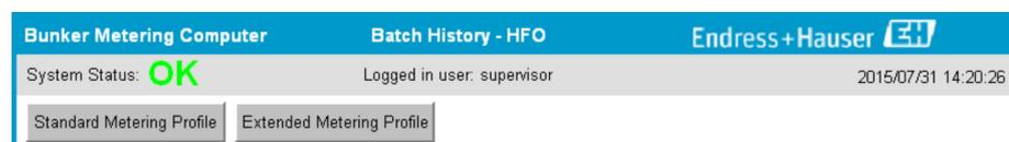
Der Benutzer **operator** kann auf die Funktion **Standard Metering Profile** zugreifen. Der Benutzer **supervisor** kann außerdem auch die Funktion **Extended Metering Profile** verwenden. Das **Standard Metering Profile** enthält die Angaben zu **Mass Flow**, **Air Index**, **Damping** und **Standard Density**. Der **Extended Metering Profile Expert** enthält zusätzliche Informationen zu Temperatur und Drücken während des Entladens.
