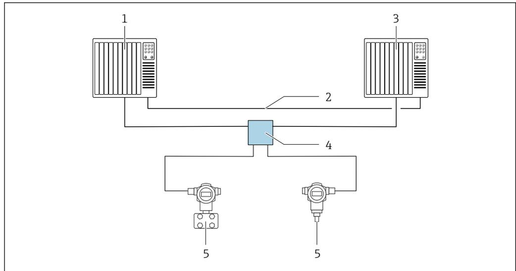
5 Beispiel für den Aufbau eines redundanten Systems (S2): Sterntopologie
