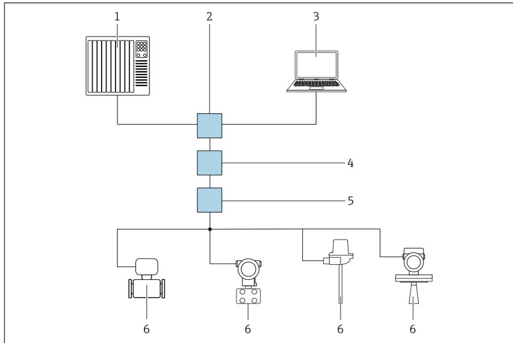
**3** Möglichkeiten der Fernbedienung via PROFINET mit Ethernet-APL Netzwerk: Stern-Topologie
