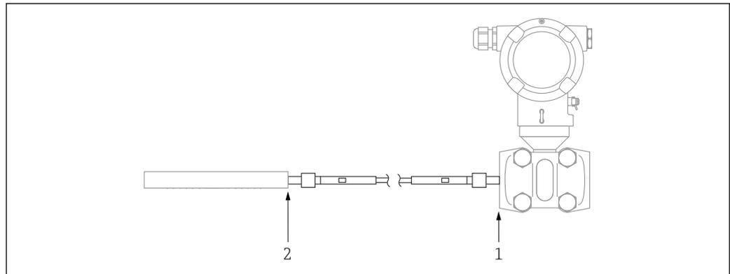
6 Die Kapillarlänge ist der Abstand zwischen dem Ovalflansch und der Rückseite des Druckmittlers. Maßeinheit mm (in)
