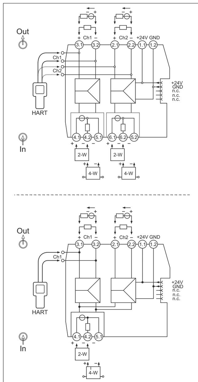
3 Klemmenbelegung: 1- und 2-Kanal Version (oben), Signaloppler (unten)
