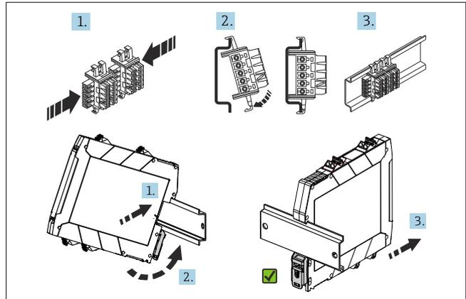
1 Montage Tragschienen-Busverbinder 12,5 mm (0,5 in) (oben) sowie Montage auf Hutschiene (unten)
