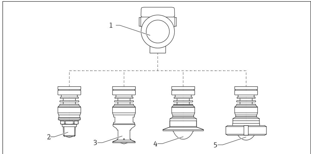
1 Produktaufbau Micropilot FMR63B
