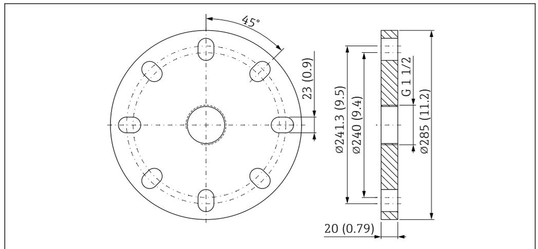
55 Abmessungen UNI Flansch 6"/DN150/150A. Maßeinheit mm (in)
