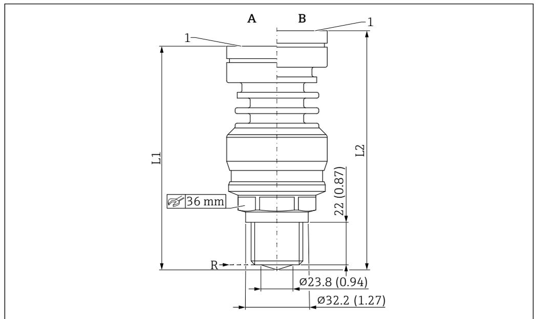
56 Abmessungen; Antenne integriert, PEEK, 20 mm (0,75 in); Prozessanschluss Gewinde 3/4". Maßeinheit mm (in)
