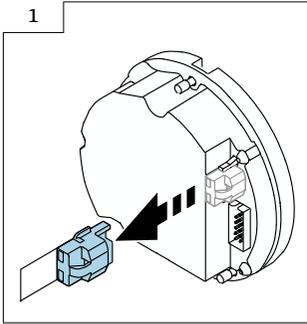
**6.2 Einkammergehäuse und Zweikammergehäuse L-Form****6.2.1 Deckel demontieren**
