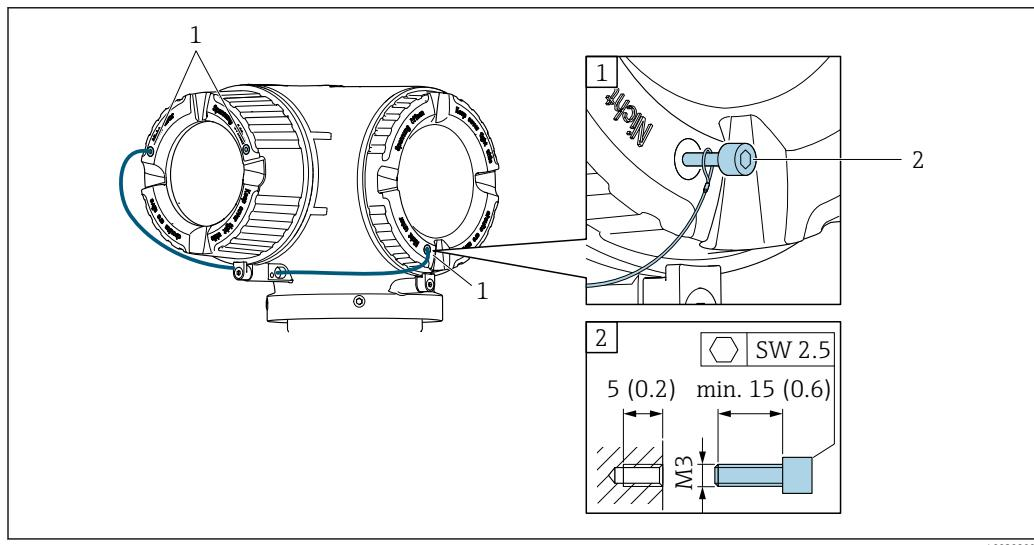
1 Furo da tampa para parafuso de fixação
