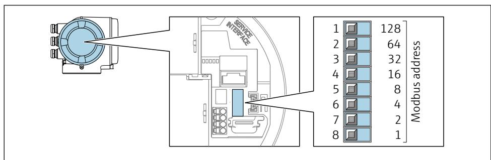
Ajuste o endereço do equipamento desejado, utilizando as minisseletoras no compartimento de conexão.
