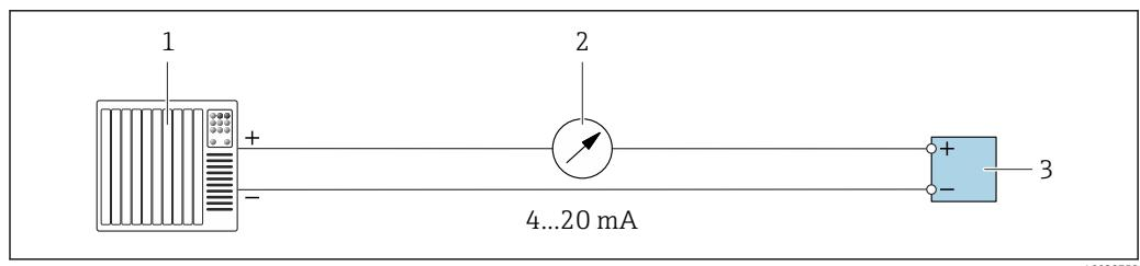
■ 13 Exemplo de conexão para saída de corrente 4-20 mA (ativa)
