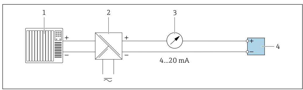
■ 14 Exemplo de conexão para saída de corrente 4-20 mA (passiva)
