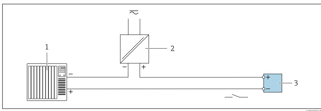
Fig. 19 Exemplo de conexão para saída a relé (passiva)
