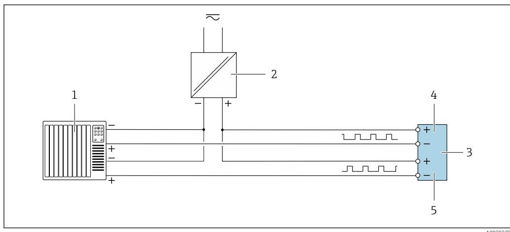
Fig. 18 Exemplo de conexão para saída de pulso duplo (passiva)
