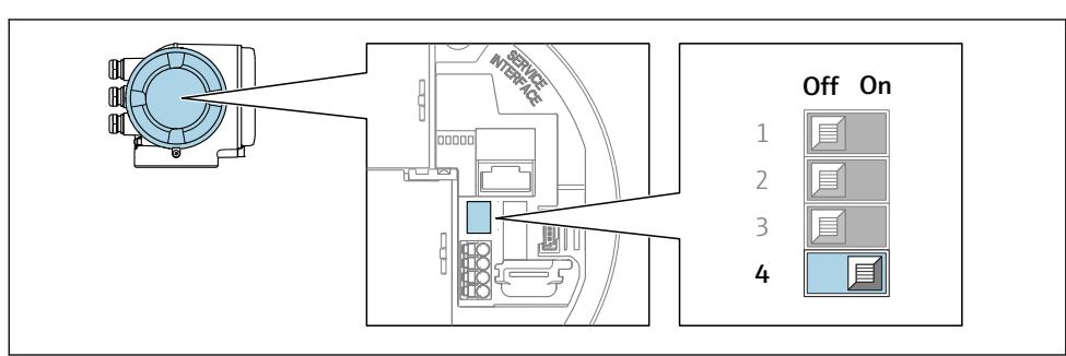
Para comutar o endereçamento de software para o endereçamento de hardware:
