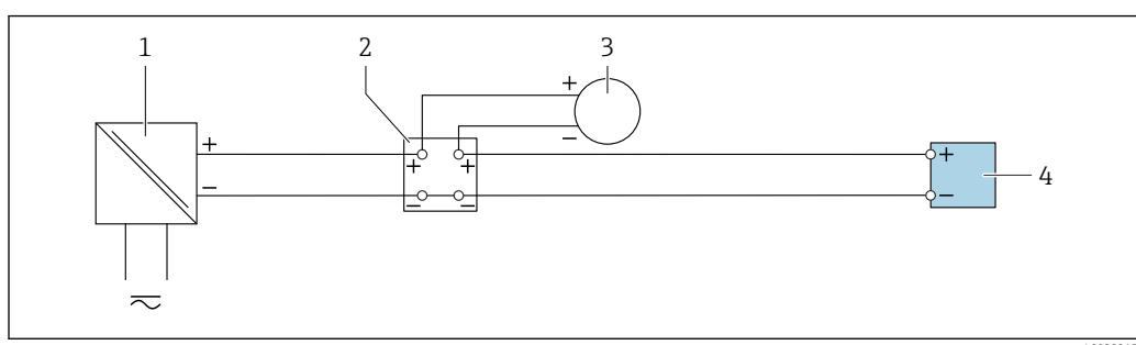
Fig. 20 Exemplo de conexão para entrada em corrente de 4 a 20 mA
