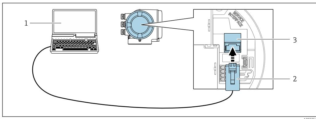
27 Conexão através de Interface de operação (CDI-RJ45)
