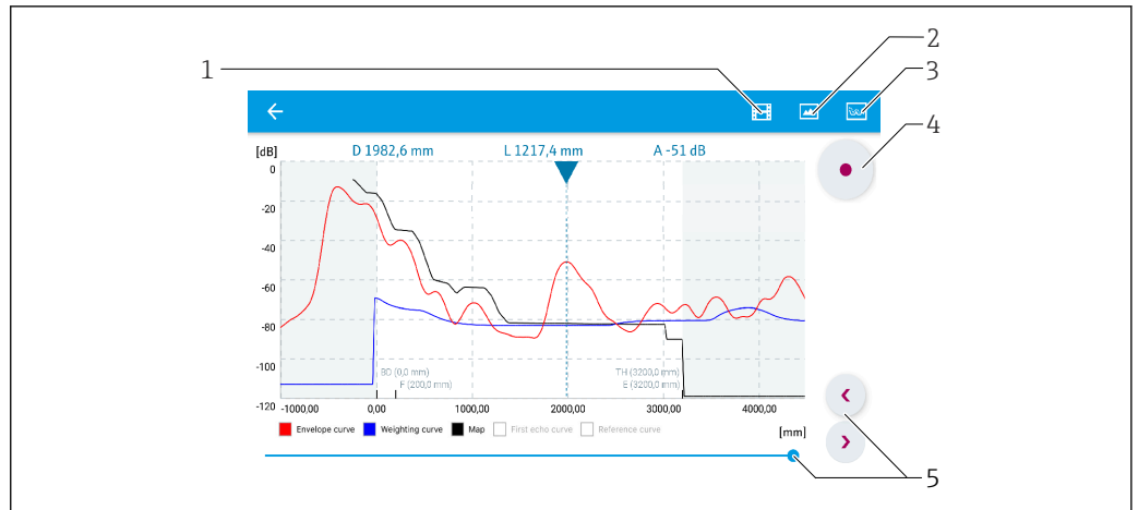
図 31 SmartBlue (Android 版) での反射波形表示 (例)
