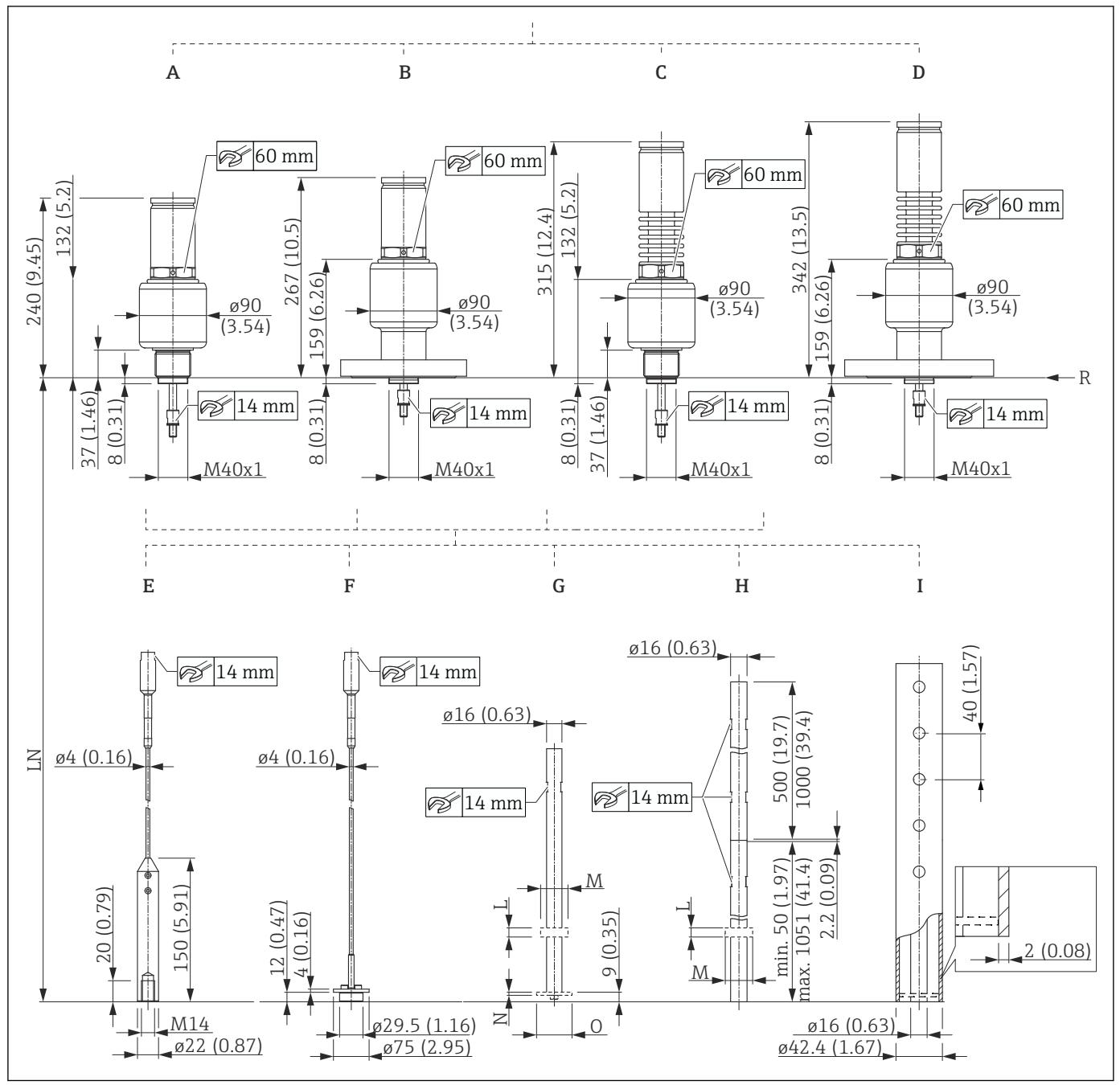
図 50 FMP54 : プロセス接続部/プローブ。測定単位 mm (in)
