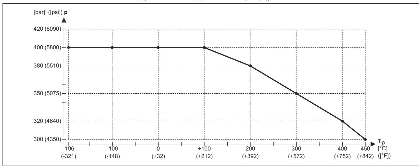
$p$  = 許容プロセス圧力 $T_p$  = プロセス温度
