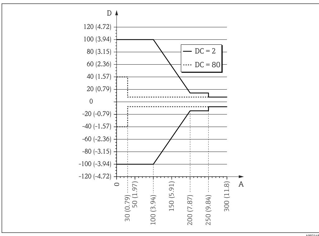
図 31 金属製センタリングディスクの場合のプローブ終端での測定誤差（製品構成：仕様コード 610「取付アクセサリ」、バージョン OA、OB または OC）
