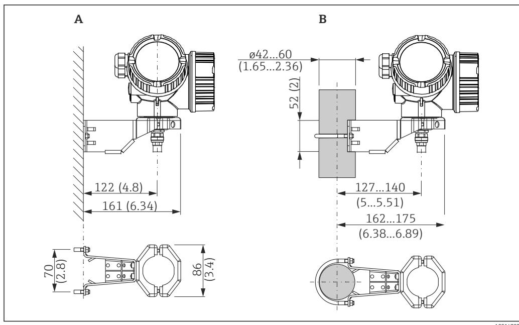
図 44 電子部ハウジングの取付ブラケット。測定単位 mm (in)
