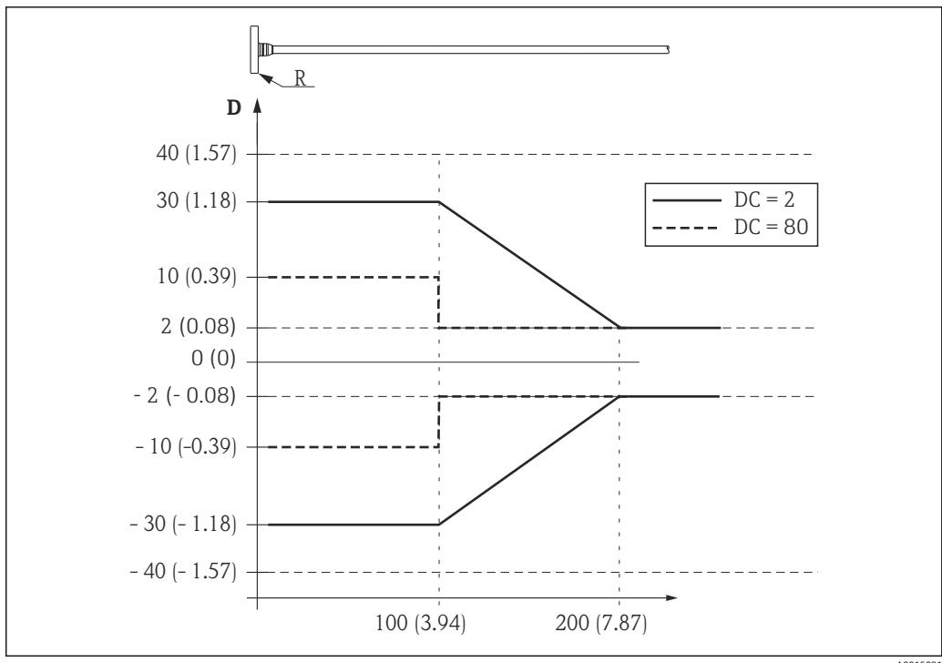
図 32 プローブ上端での測定誤差；単位 mm (in)
