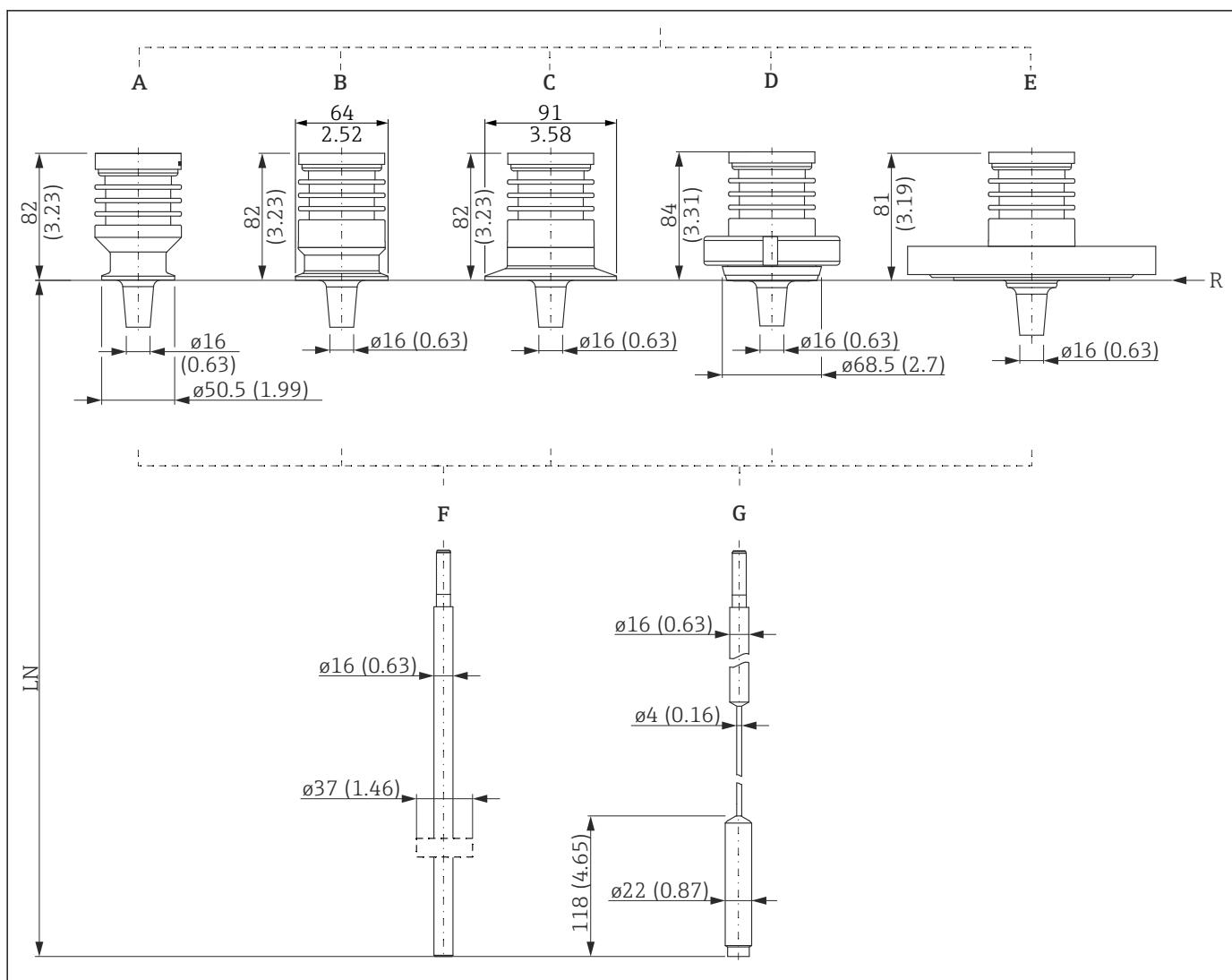
図 49 FMP52 : プロセス接続部/プローブ。測定単位 mm (in)
