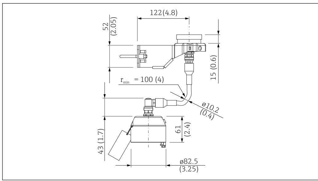
図 45 分離型プローブの接続部；接続ケーブルの長さ：注文に応じて。測定単位 mm (in)
