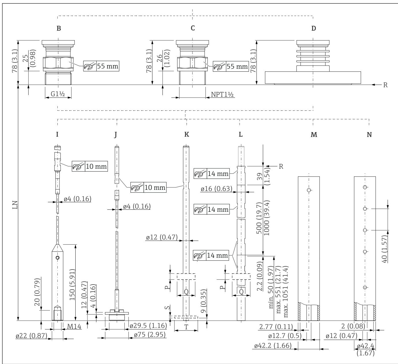
図 4.7 EMP51：プロセス接続部/プローブ 測定単位 mm (in)
