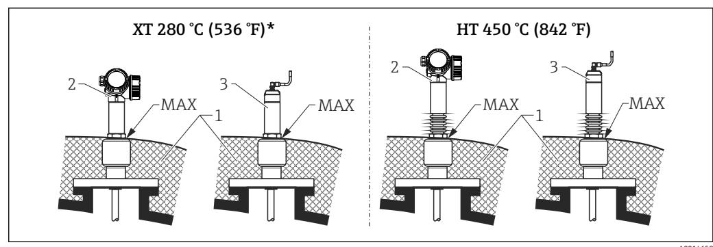
図 40 プロセス接続（フランジ） - センサバージョン XT および HT
