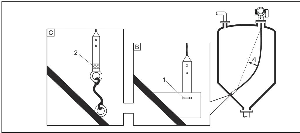
A ロープのたるみ :  $\geq 10 \text{ mm} / (1 \text{ m プローブ長}) [0.12 \text{ in} / (1 \text{ ft プローブ長})]$
