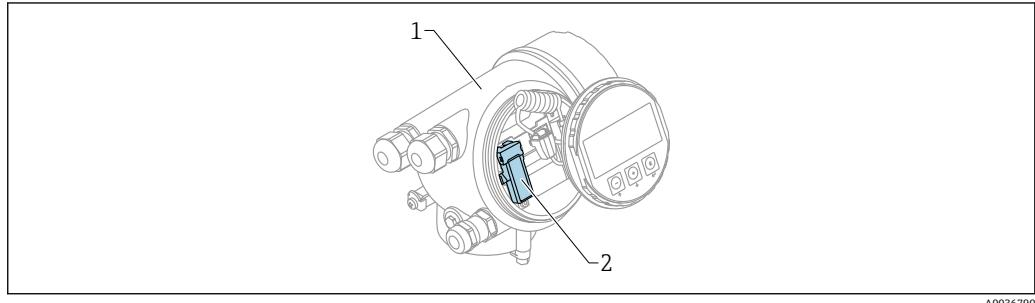
図 56 Bluetooth モジュール搭載の機器
