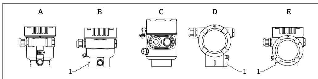
A Пластмассовый корпус с одним отсеком (без стопорного винта)
