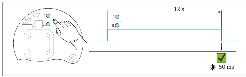
図 16 エレクトロニックインサートの操作キー
