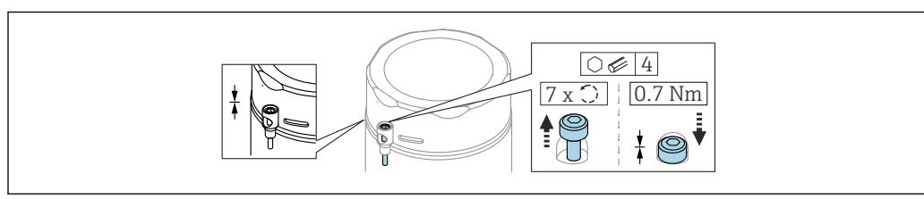
図 3 固定ネジ付きカバー、サニタリハウジング（粉塵防爆用のみ）
