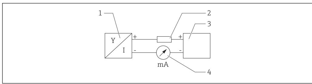
図 4 HART 接続のブロック図
