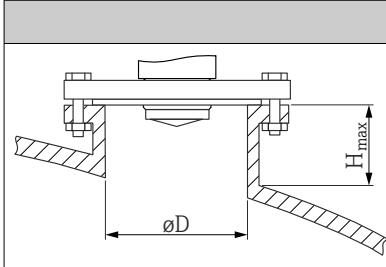
**i** これより長いノズルを使用した場合、測定性能が低下します
