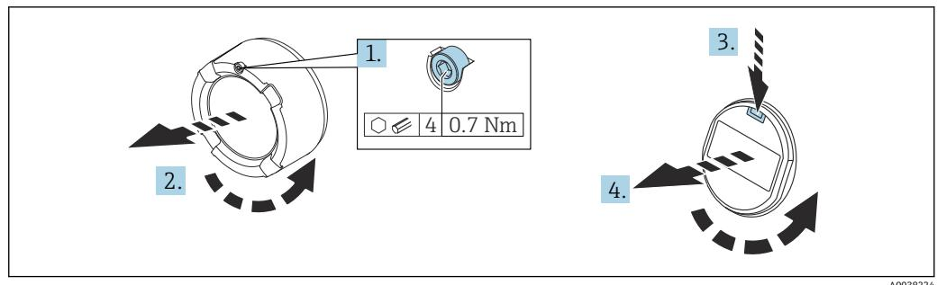
1. (取り付けている場合) 六角レンチを使用して、表示部カバーのカバーロックのネジを緩めます。
