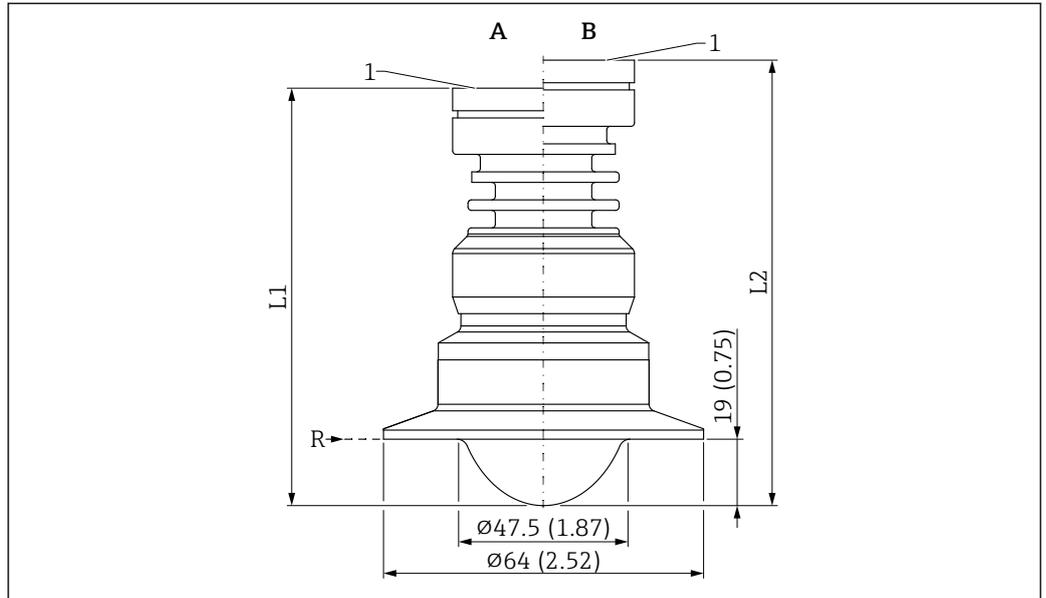
37 PTFE 外装付フラッシュマウントアンテナ (50 mm (2 in)、トリクランプ DN51 (2") ISO2852 付き) の寸法。測定単位 mm (in)
