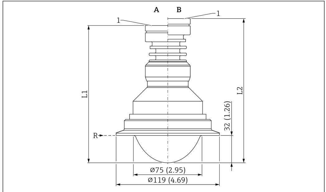
39 PTFE 外装付フラッシュマウントアンテナ (80 mm (3 in)、トリクランプ DN101.6 (4") ISO2852 付き) の寸法。測定単位 mm (in)
