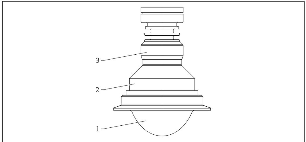
図 44 材質；PTFE 外装付フラッシュマウントアンテナ、80 mm (3 in)、トリクランプ ISO2852 付き
