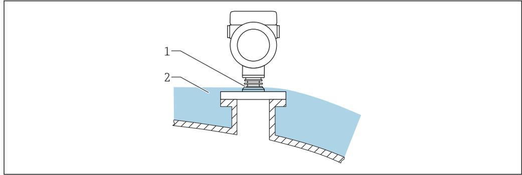
プロセス温度が高い場合は、熱の放射や伝達により電子回路部が過熱しないよう、機器をタンク断熱システム (2) に設置してください。リブ構造 (1) は断熱しないでください。
