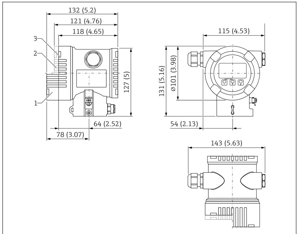
図 32 デュアル端子箱部の寸法。測定単位 mm (in)
