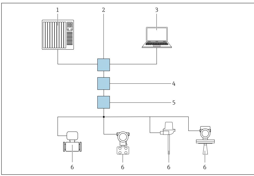
图 64 通过 PROFINET + Ethernet-APL 网络实现远程操作：星形拓扑结构
