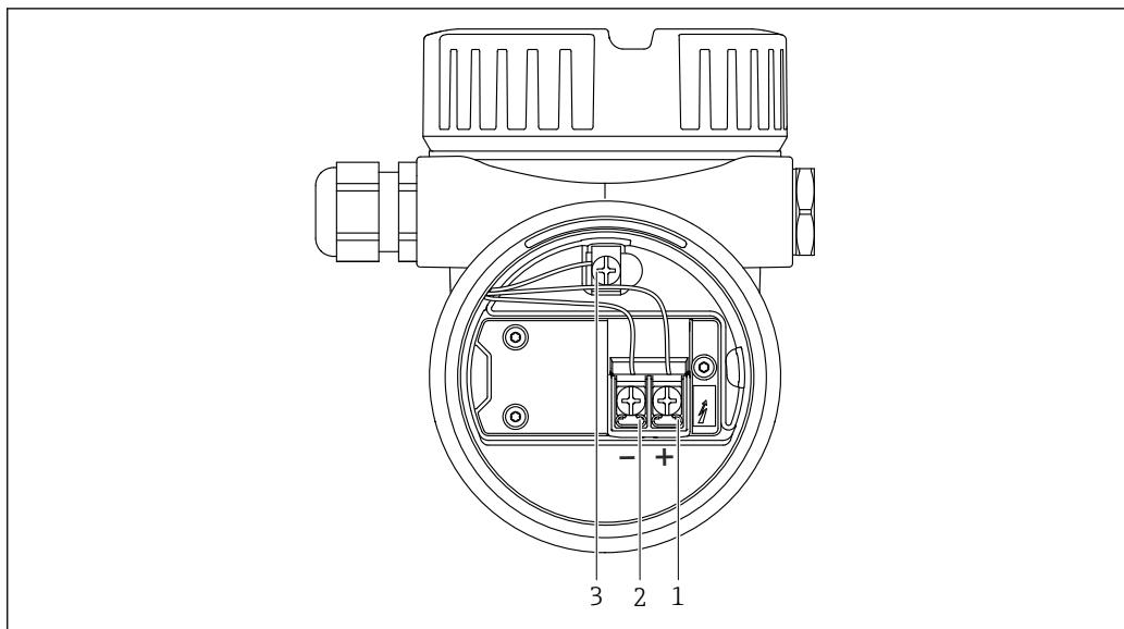
图 6 接线腔中的接线端子和接地端
