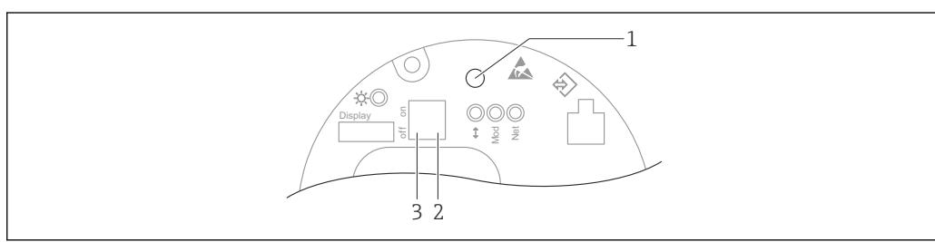
图 62 Ethernet-APL 电子插件上的操作按键和 DIP 开关
