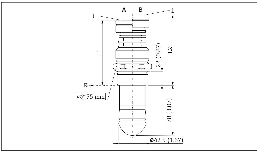
图 51 水滴型天线 (50 mm (2 in)口径) 的外形尺寸示意图; 螺纹过程连接。测量单位 mm (in)
