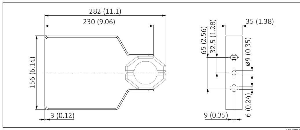
图 68 安装架的外形尺寸示意图。测量单位 mm (in)
