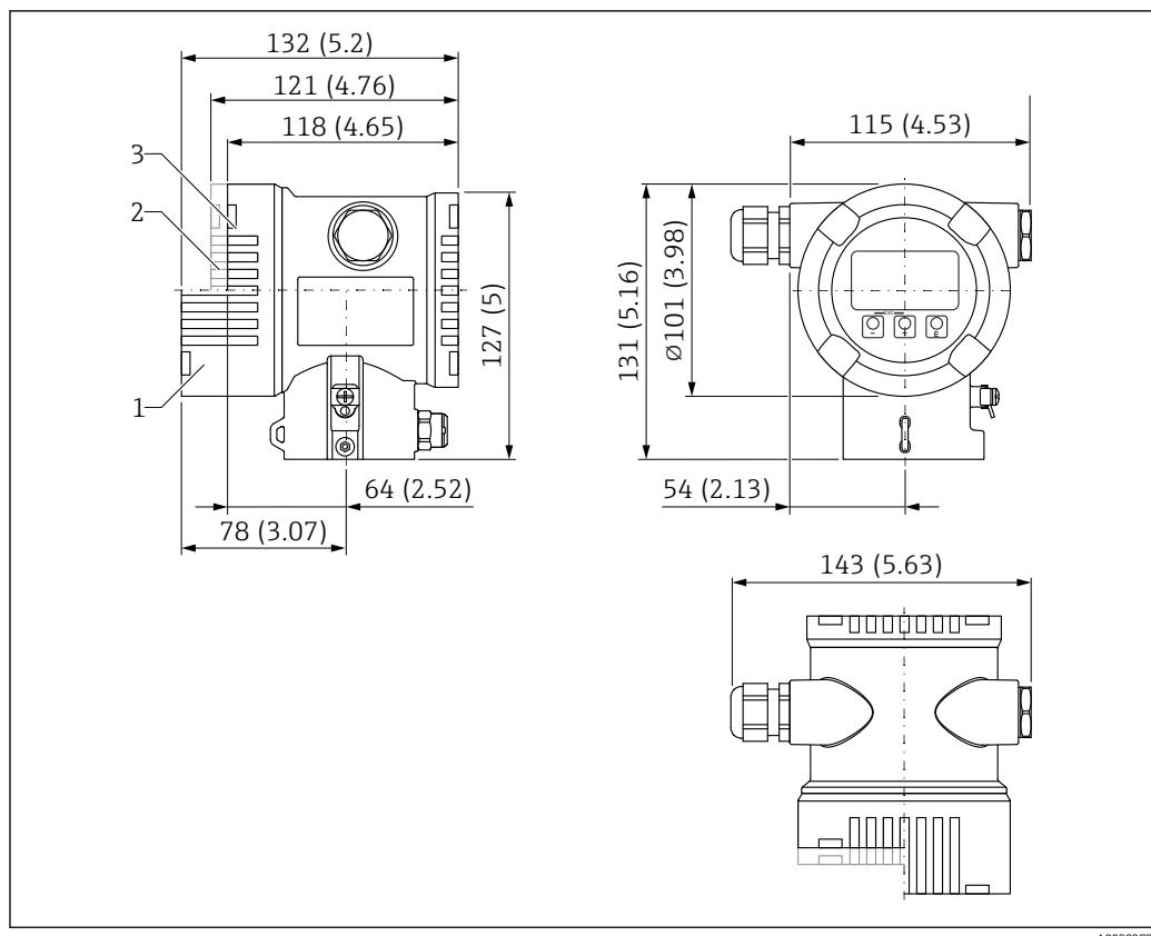
图 44 双腔室外壳的外形尺寸示意图。测量单位 mm (in)
