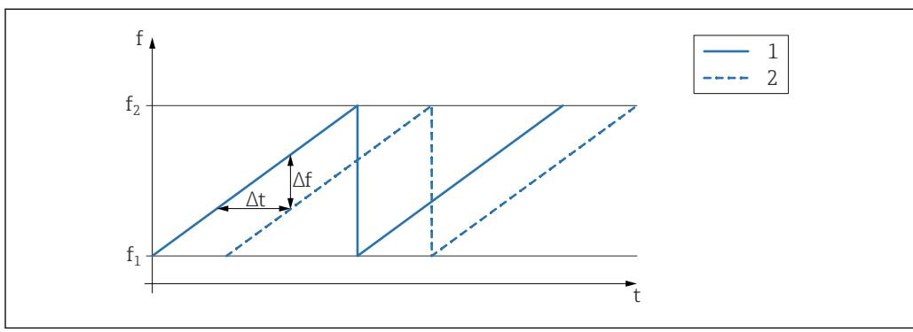
图 2 FMCW 原理：调频结果
