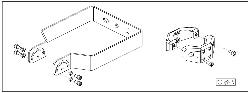
图 69 安装架 (可调节) 的供货清单
