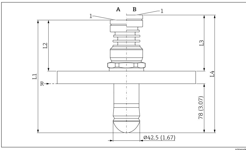
图 52 水滴型天线 (50 mm (2 in)口径) 的外形尺寸示意图; UNI 法兰过程连接。测量单位 mm (in)
