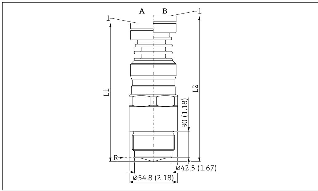
图 57 PEEK 一体式天线 (40 mm (1.5 in)口径) 的外形尺寸示意图; 1-1/2"螺纹过程连接。测量单位 mm (in)
