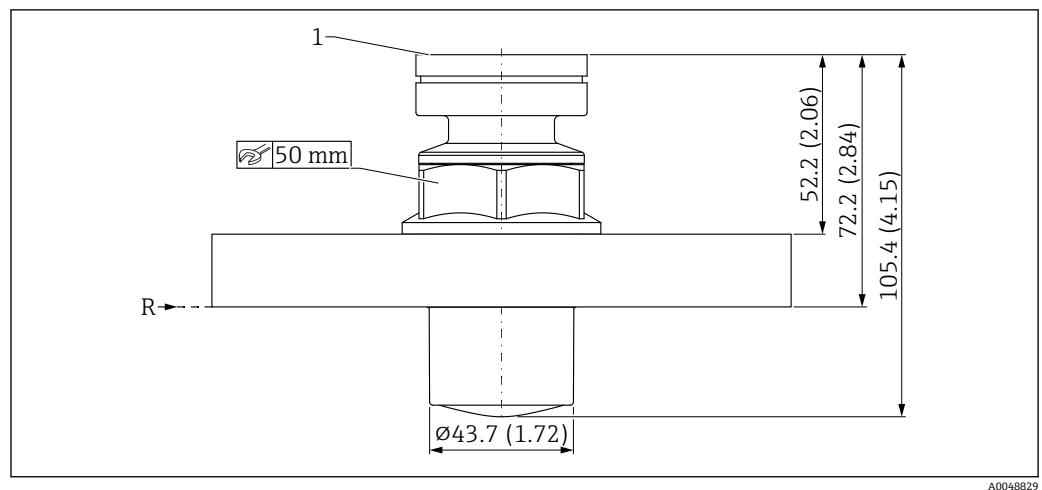
图 47 PVDF 全密封天线 (40 mm (1.5 in)口径) 的外形尺寸示意图; UNI 法兰过程连接。测量单位 mm (in)
