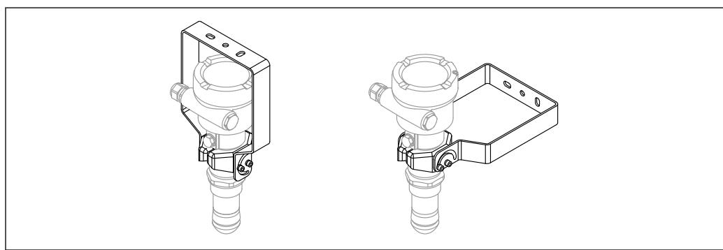
图 67 安装在罐顶或墙壁上
