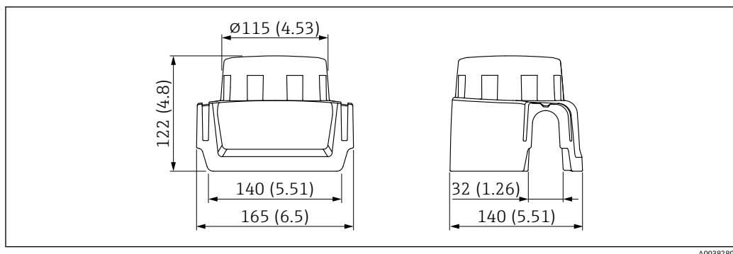
图 66 外形尺寸示意图。测量单位 mm (in)
