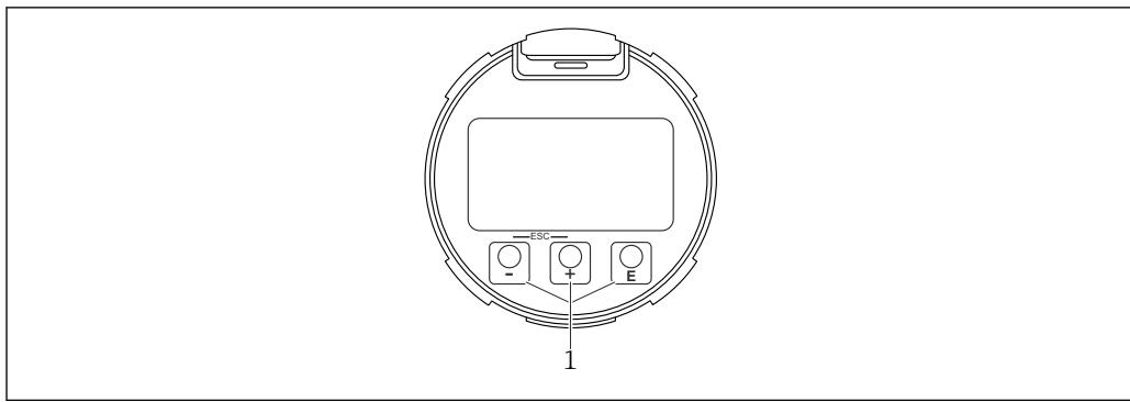
图 63 图形显示单元，带光敏按键 (1)
