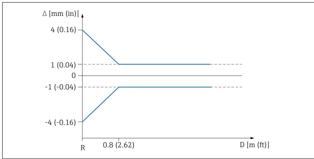
图 9 近距离测量时的最大测量误差
