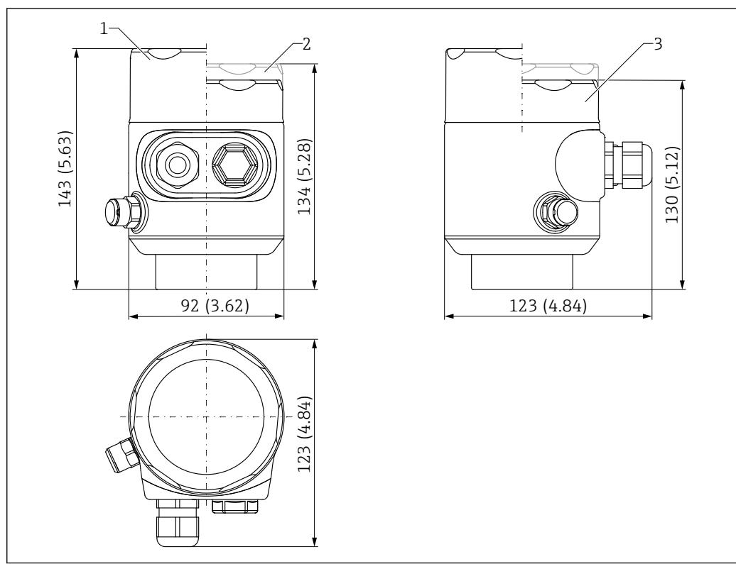
图 43 316L 单腔室外壳（卫生型）的外形尺寸示意图。测量单位 mm (in)
