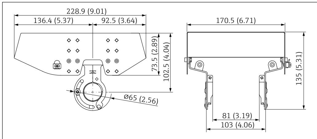
图 65 外形尺寸示意图。测量单位 mm (in)
