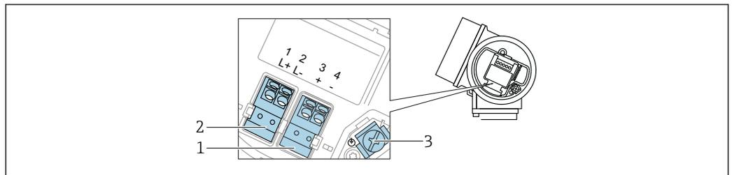
10 Esquema de ligação elétrica, 4 fios: 4 para 20 mA HART (10.4 para 48 V<sub>DC</sub>)
