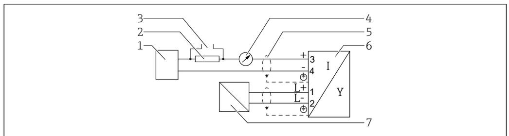
11 Diagrama de bloco, 4 fios: 4 para 20 mA HART (10.4 para 48 V<sub>DC</sub>)
