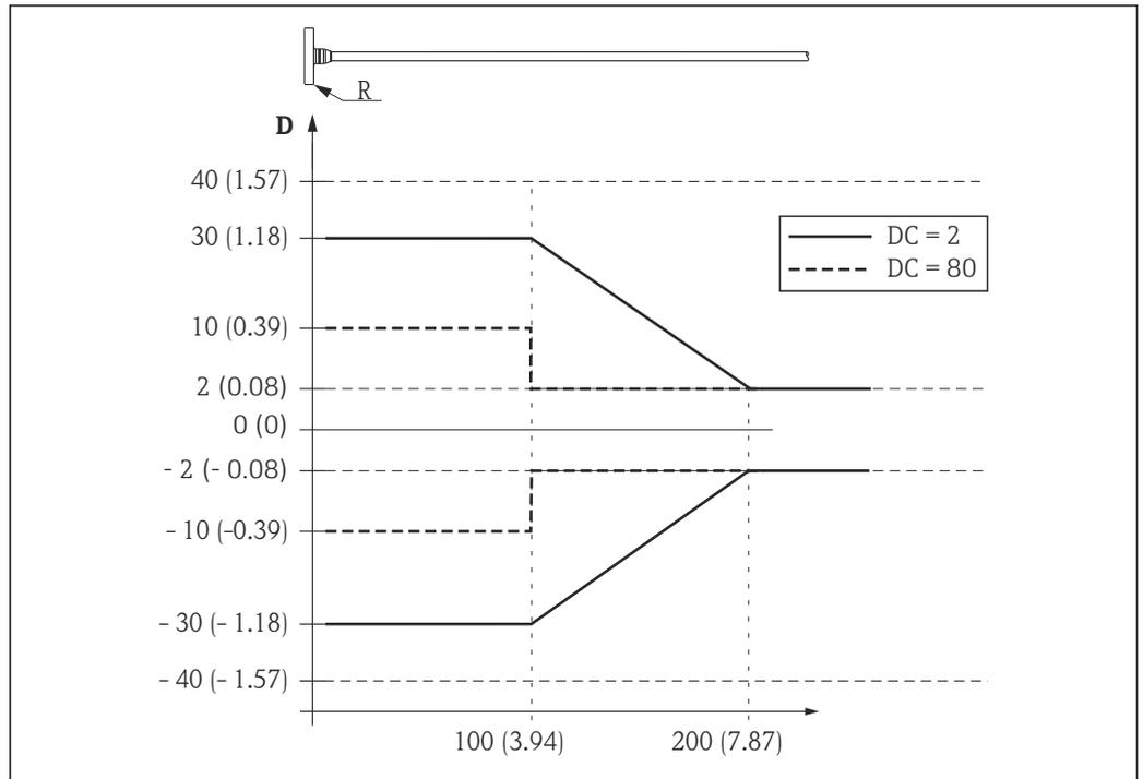
21 Erro de medição na extremidade superior da haste; unidade de engenharia: mm (pol.)
