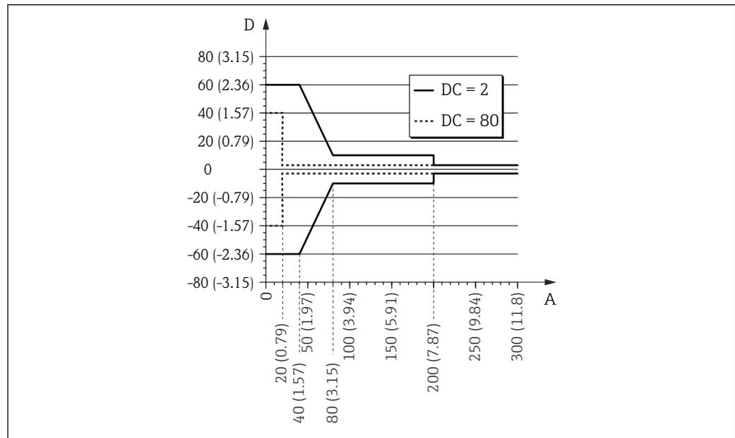
20 Erro de medição na extremidade da haste para hastes rígidas e hastes coaxiais
