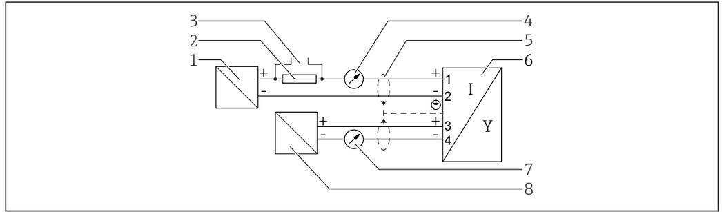
9 Diagrama de bloco, 2 fios: 4 para 20 mA HART 4 para 20 mA
