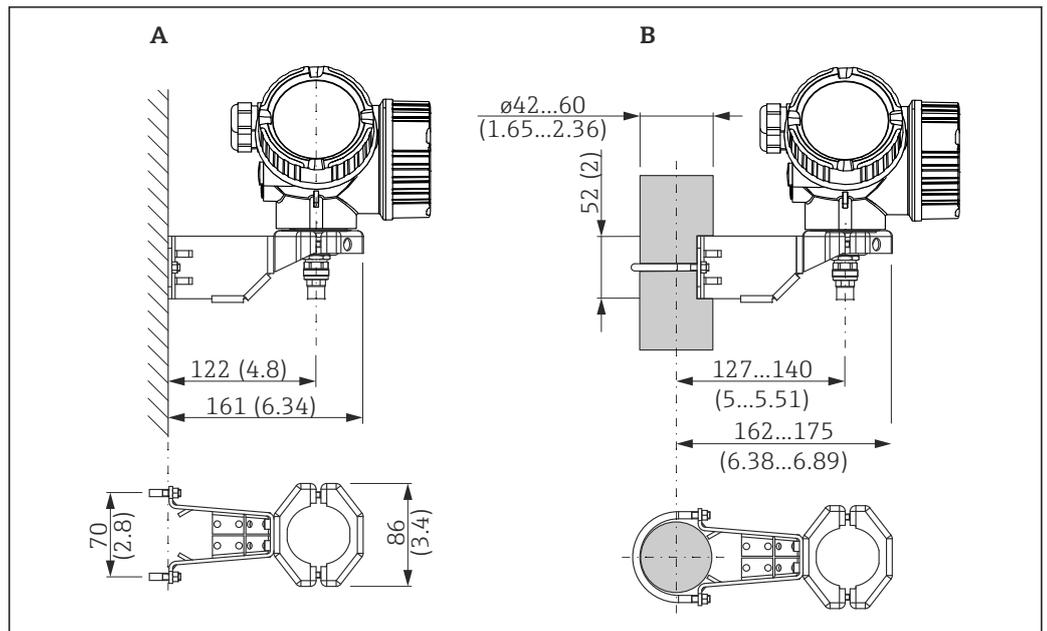
26 Suporte de montagem para o invólucro dos componentes eletrônicos. Unidade de medida mm (in)
