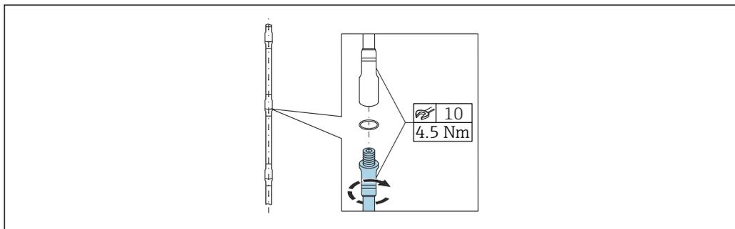
Em condições de instalação confinadas (pouca distância do teto), é aconselhável o uso de hastes rígidas separáveis ( $\varnothing$  8 mm).
