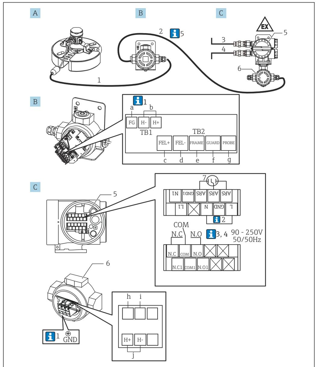
21 Cableado del convertidor Ex d [ia] NRR261-5
