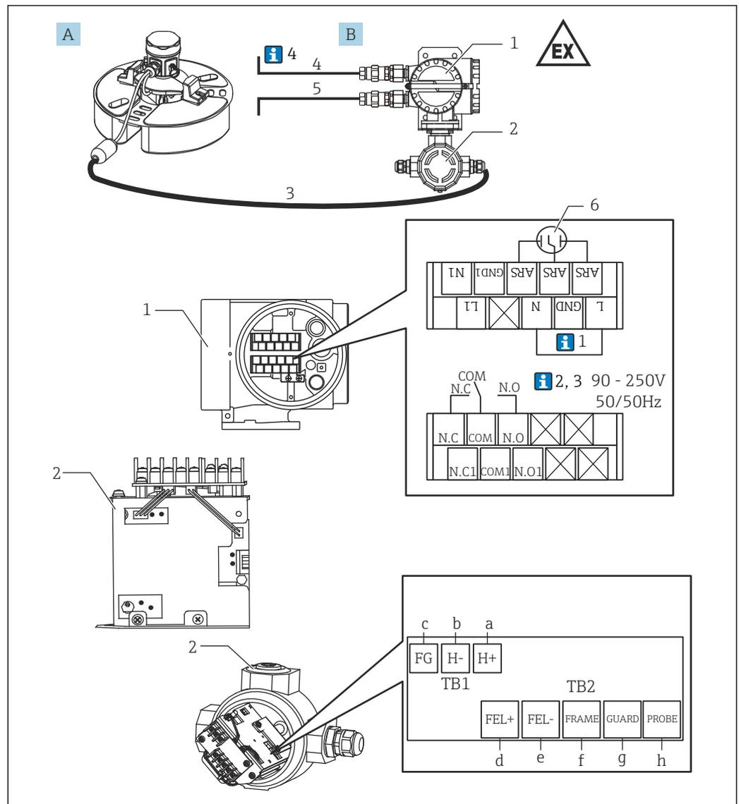
19 Cableado del convertidor Ex d [ia] NRR261-4/A/B/C
