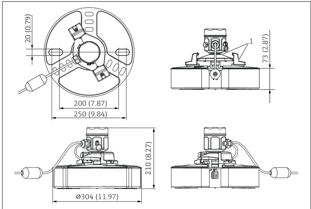
8 Esquema del sensor de flotador NAR300. Unidad de medida mm (in)
