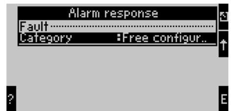
2. Выберите вход расхода (Setup/Inputs/Flow..., здесь, для примера, выбран Promag) и назначьте желаемые пределы диапазона и функции при возникновении аварии в "Alarm Response".
