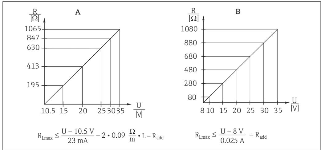
A 4 ... 20 mA 模拟量通信型仪表的负载曲线图，用于估算负载电阻。必须从计算值中减去延长电缆电阻等附加电阻，如上述公式所示。
