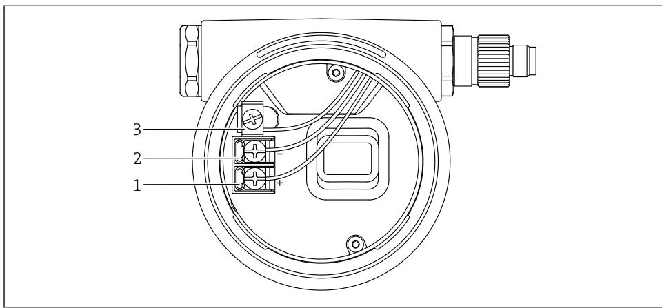
图 3 接线腔中的接线端子和接地端
