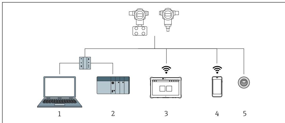
图 6 通过 PROFINET 通信实现远程操作
