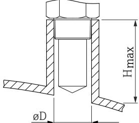
**i** 如果超出最大安装短管高度, 肯定会降低测量性能。
