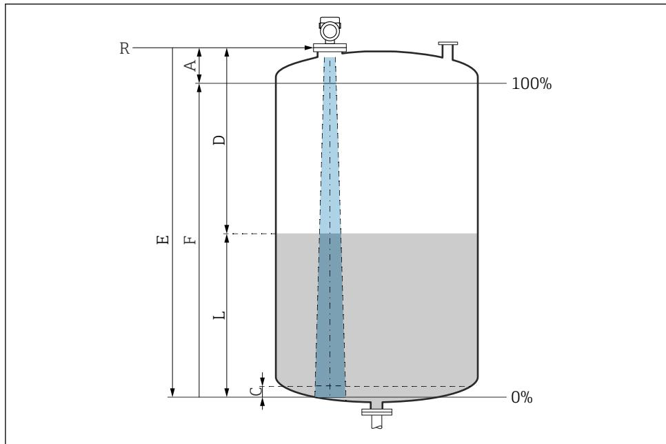
图 7 液位测量的设置参数
