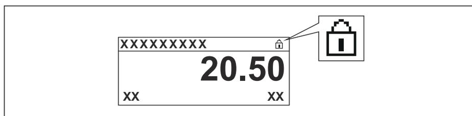
Если аппаратная защита от записи деактивирована: опции в параметре параметр **Статус блокировки** не отображаются. Прекращается отображение символа
