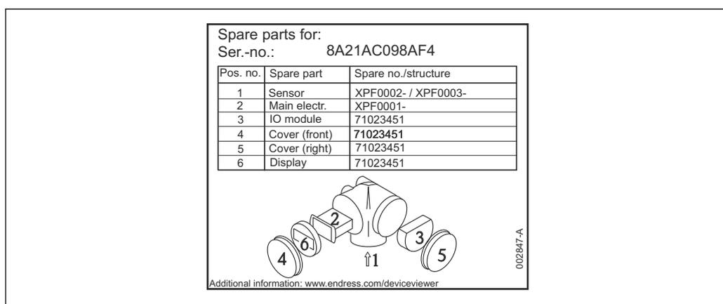
26 Пример заводской таблички с перечнем запасных частей, размещаемой на крышке присоединительного отсека
