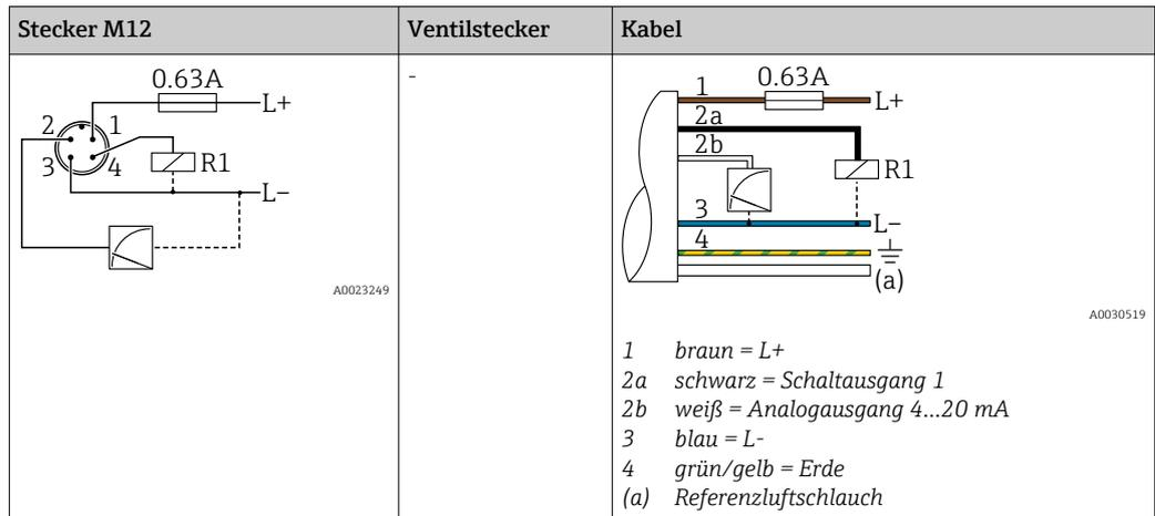
IO-Link: 1 x PNP Schaltausgang R1 mit zusätzlichem Analogausgang 4...20 mA (aktiv)
