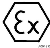
그림 3. 위험 지역 사용이 가능함을 보여주는 ATEX 라벨
