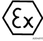
그림 6. 위험 지역 사용이 가능함을 보여주는 ATEX 라벨
